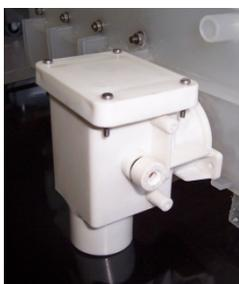
**Figura 2 - coperchio con feritoie per uscita vapore**
