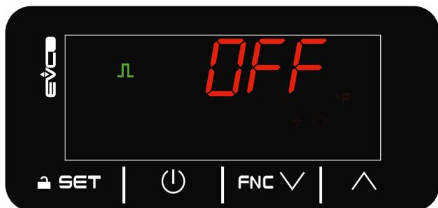
Fig. 26. Fonctionnement ON/OFF - ID1 et ID2 ouvertes
