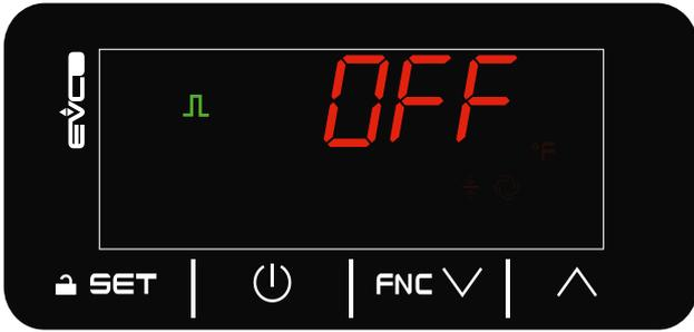
Abb. 26. ON/OFF-Betriebsart - ID1 und ID2 geöffnet
