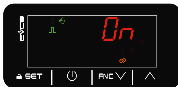
Fig. 27. Funcionamiento ON/OFF - ID1 e ID2 cerrada
