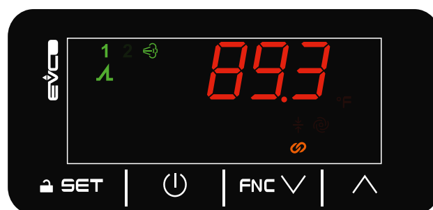
Fig. 31. Funcionamiento proporcional - ID1 e ID2 cerrada
