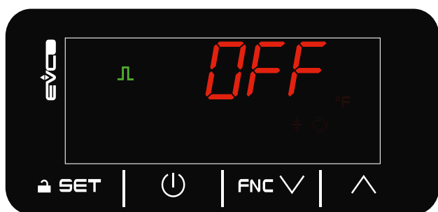
Fig. 26. Funcionamiento ON/OFF - ID1 e ID2 abierta
