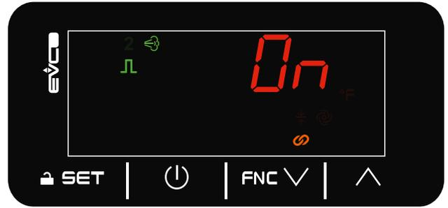
Fig. 27. Funcionamiento ON/OFF - ID1 e ID2 cerrada
