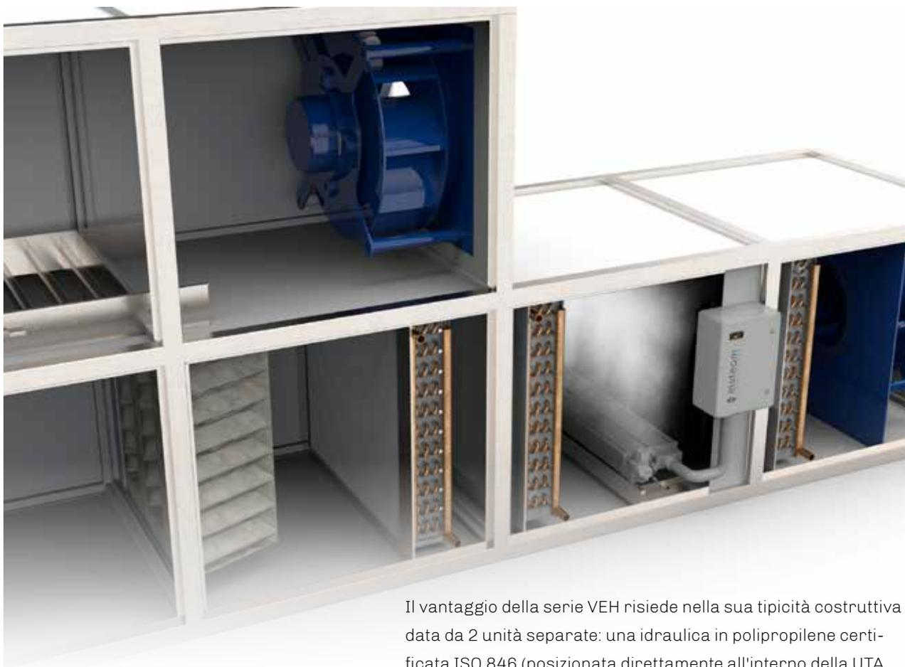
Il vantaggio della serie VEH risiede nella sua tipicità costruttiva data da 2 unità separate: una idraulica in polipropilene certificata ISO 846 (posizionata direttamente all'interno della UTA senza tubi di distribuzione per un rilascio ottimale del vapore con contributo al riscaldamento) e una elettrica di controllo con protezione IP55 che non necessita di vano tecnico.
