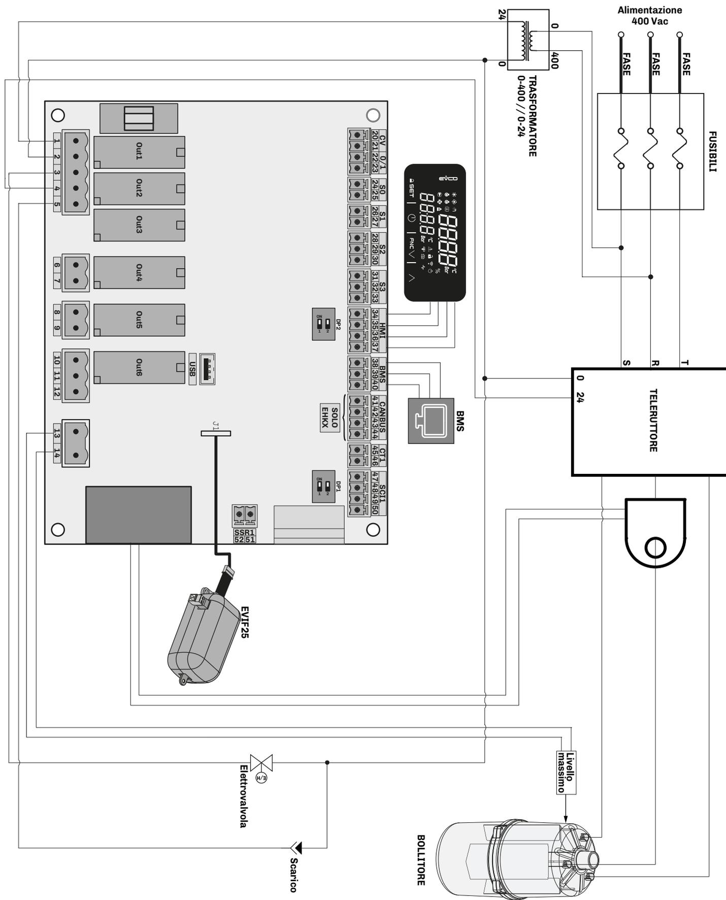
Fig. 120. Schema elettrico modelli EHKT003T4 / EHKT005T4 / EHKT010T4 / EHKT015T4
