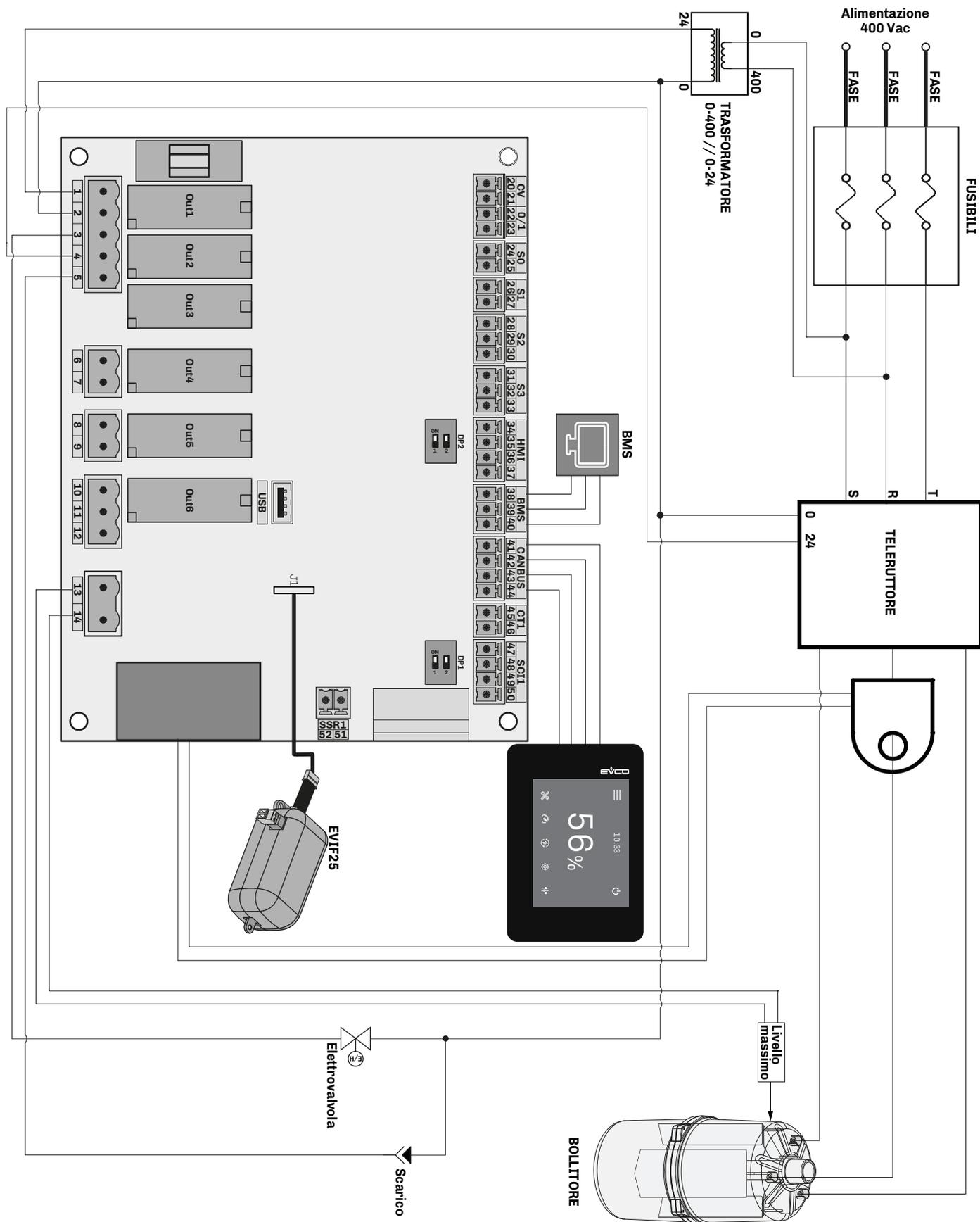
Fig. 124. Schema elettrico modelli EHKX003T2 / EHKX005T2 / EHKX010T2
