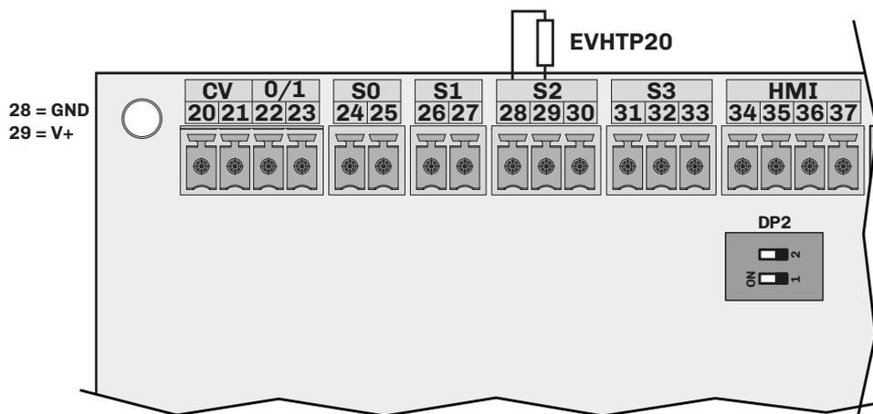
Fig. 97. Collegamento sonda di umidità EVHTP520 (CFG = HUM)
