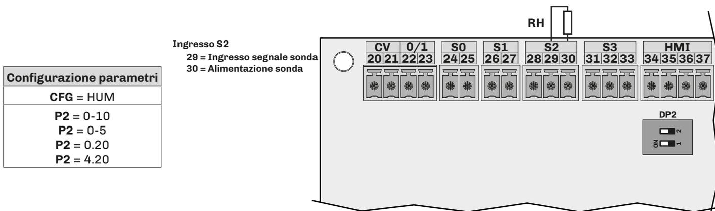
Fig. 96. Collegamento sonda di umidità (CFG = HUM)
