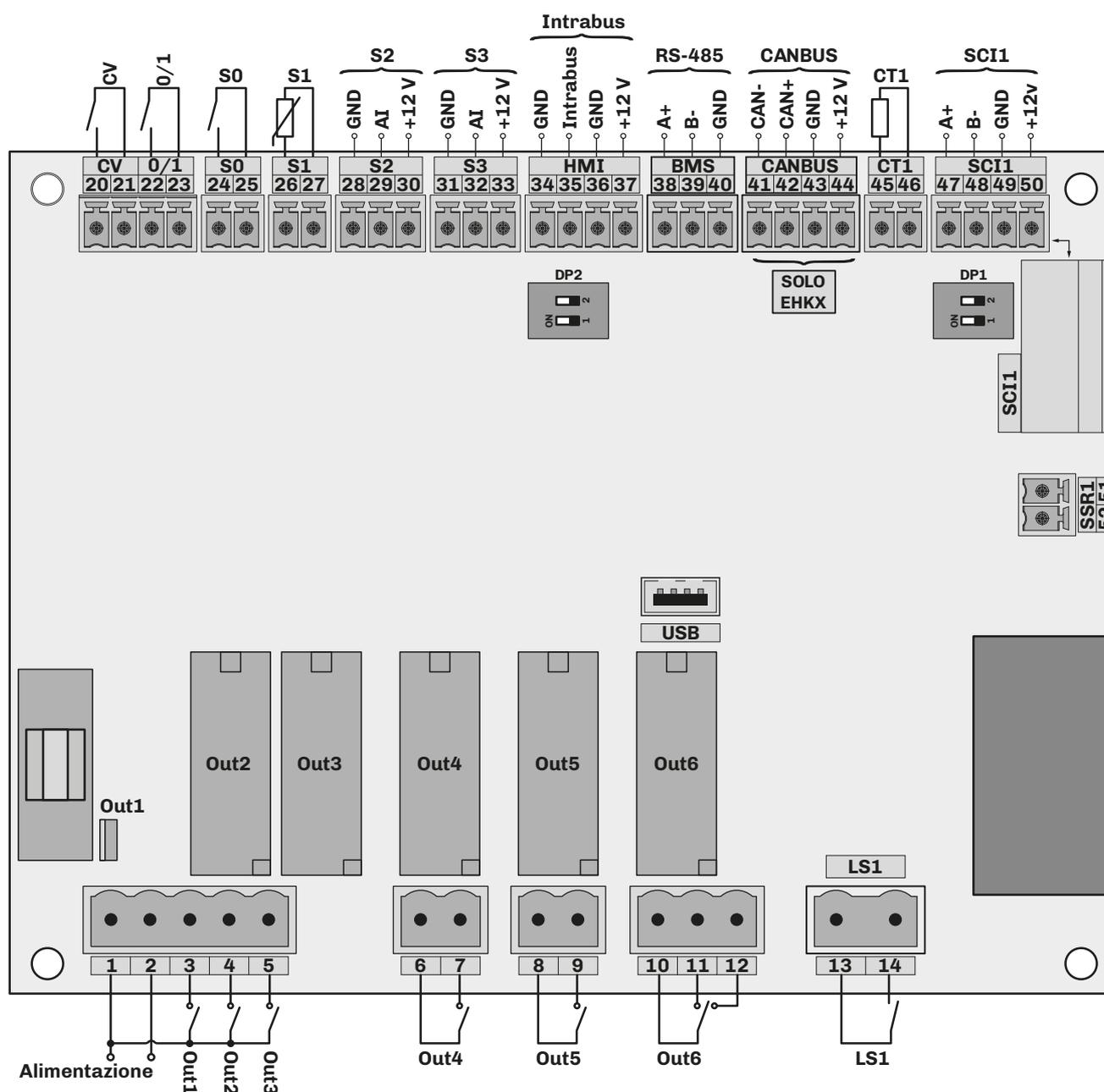
Fig. 92. Collegamenti elettrici scheda di controllo
