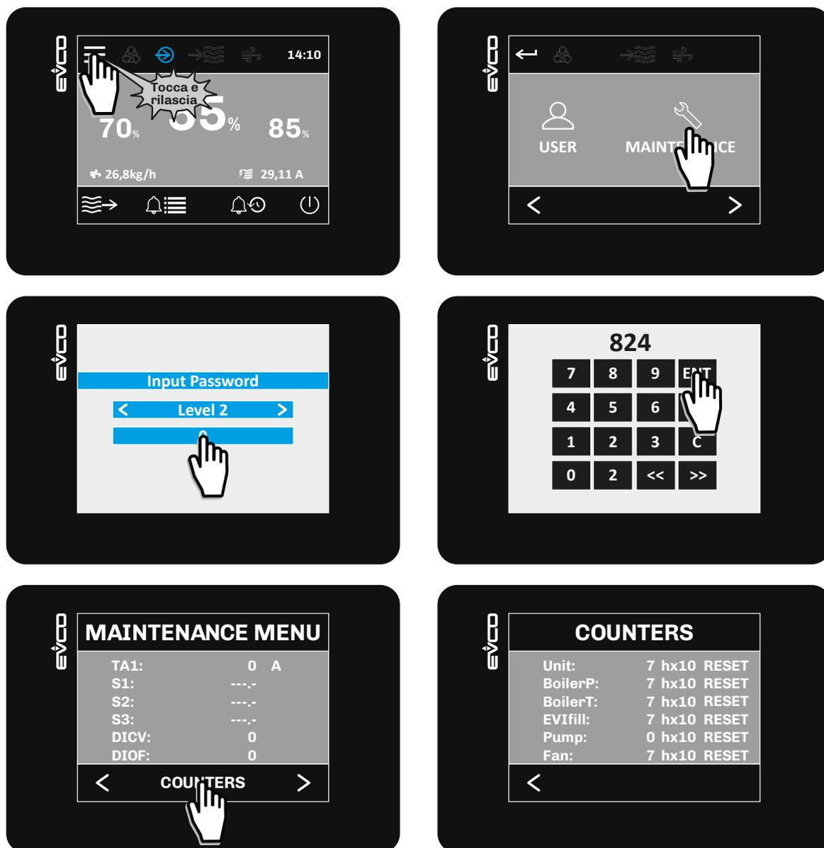
Fig. 75. Visualizzazione ore funzionamento
