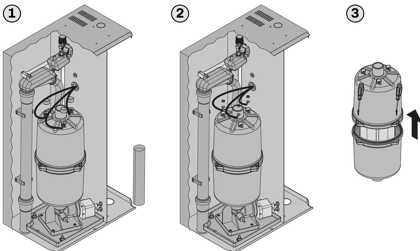
Fig. 114. Sostituzione bollitore
