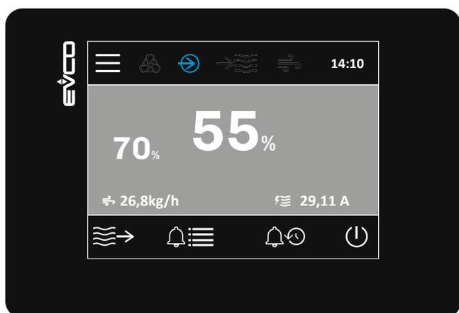
Fig. 20. Schermata di Home solo con sonda umidità
