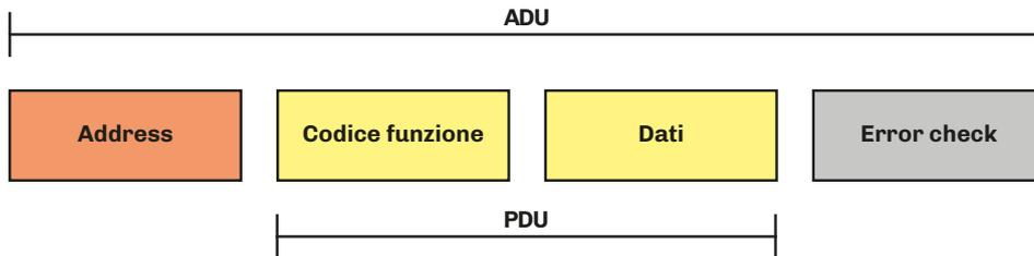
Fig. 70. Framing di un messaggio utilizzando il protocollo Modbus
