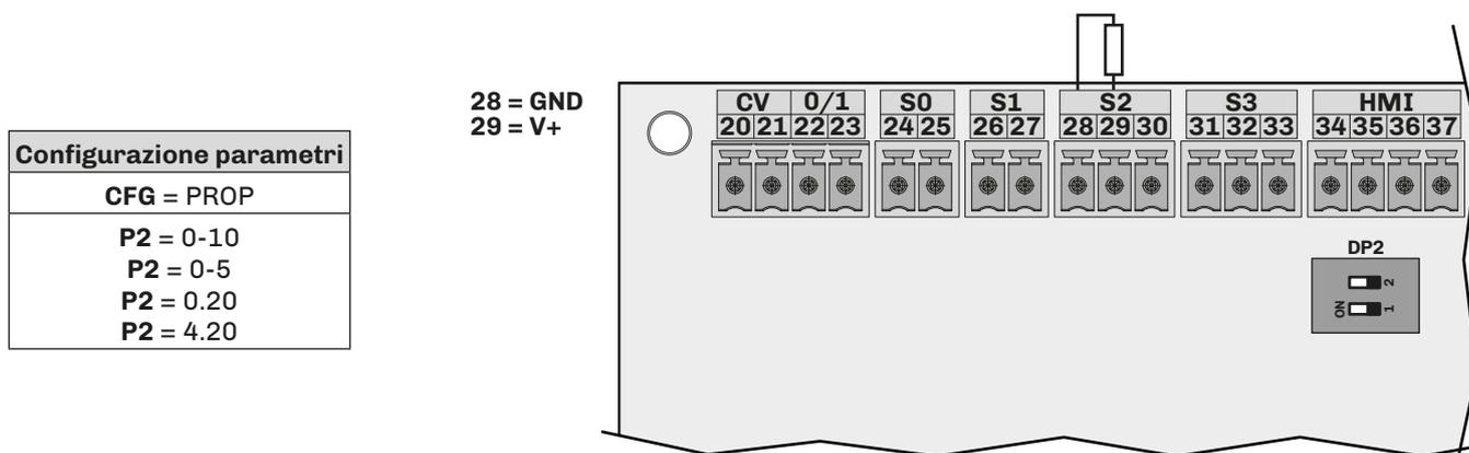
Fig. 57. Collegamento umidostato proporzionale esterno (CFG = PROP)
