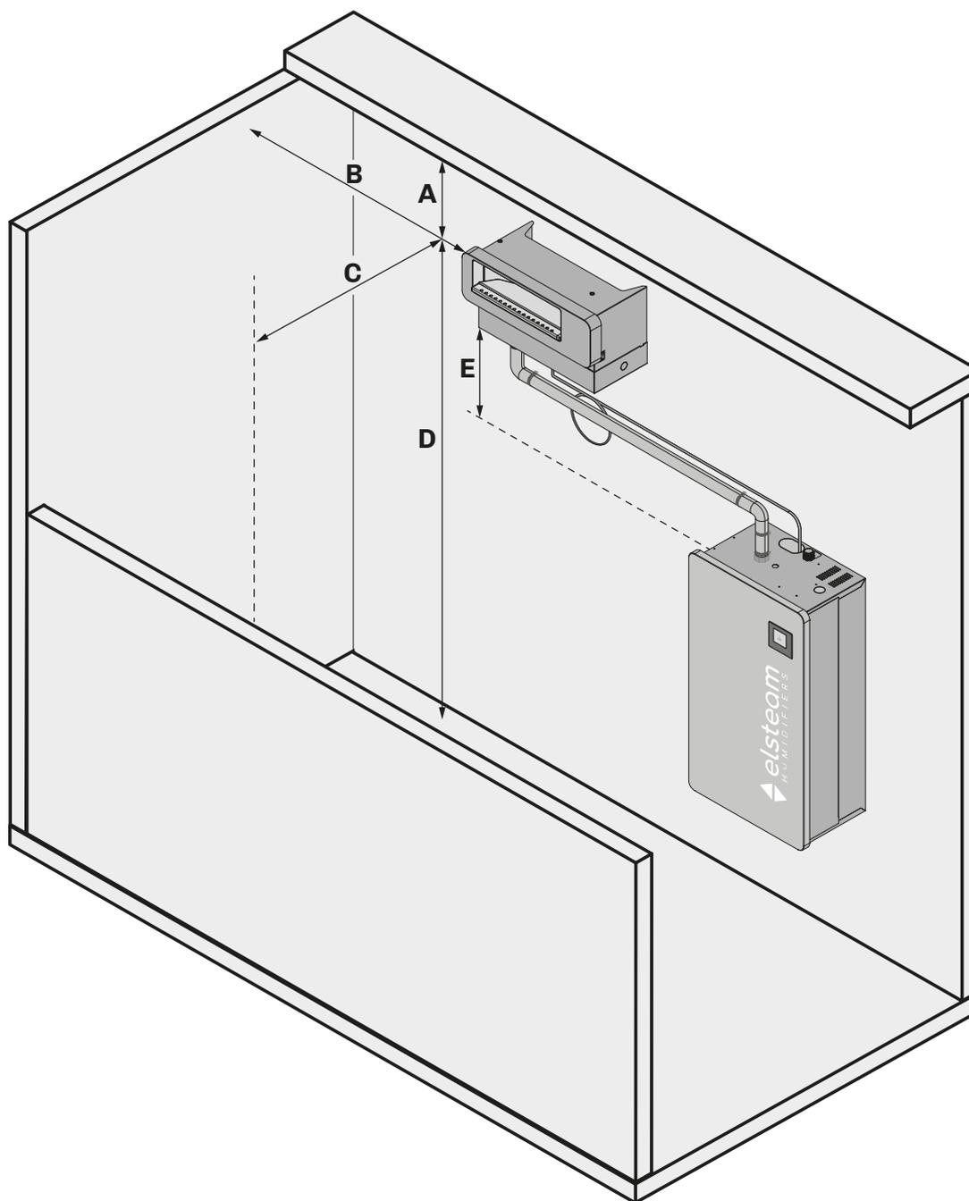
**Fig. 41.** Distanze minime con montaggio remoto
