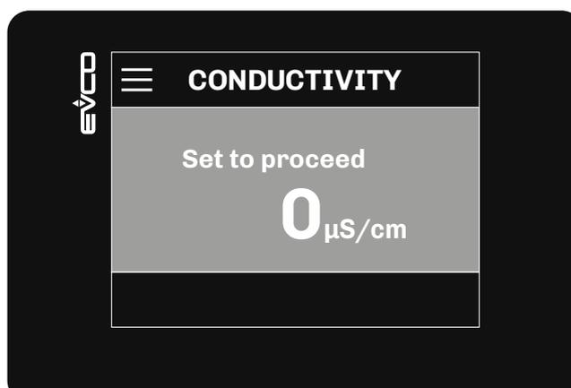
Fig. 16. Primo avvio - Impostazione conducibilità elettrica
