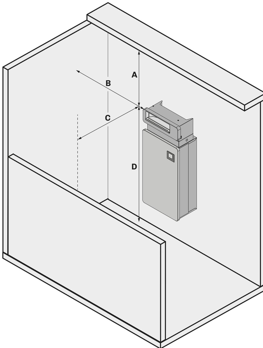
**Fig. 42.** Distanze minime con montaggio sopra l'umidificatore
