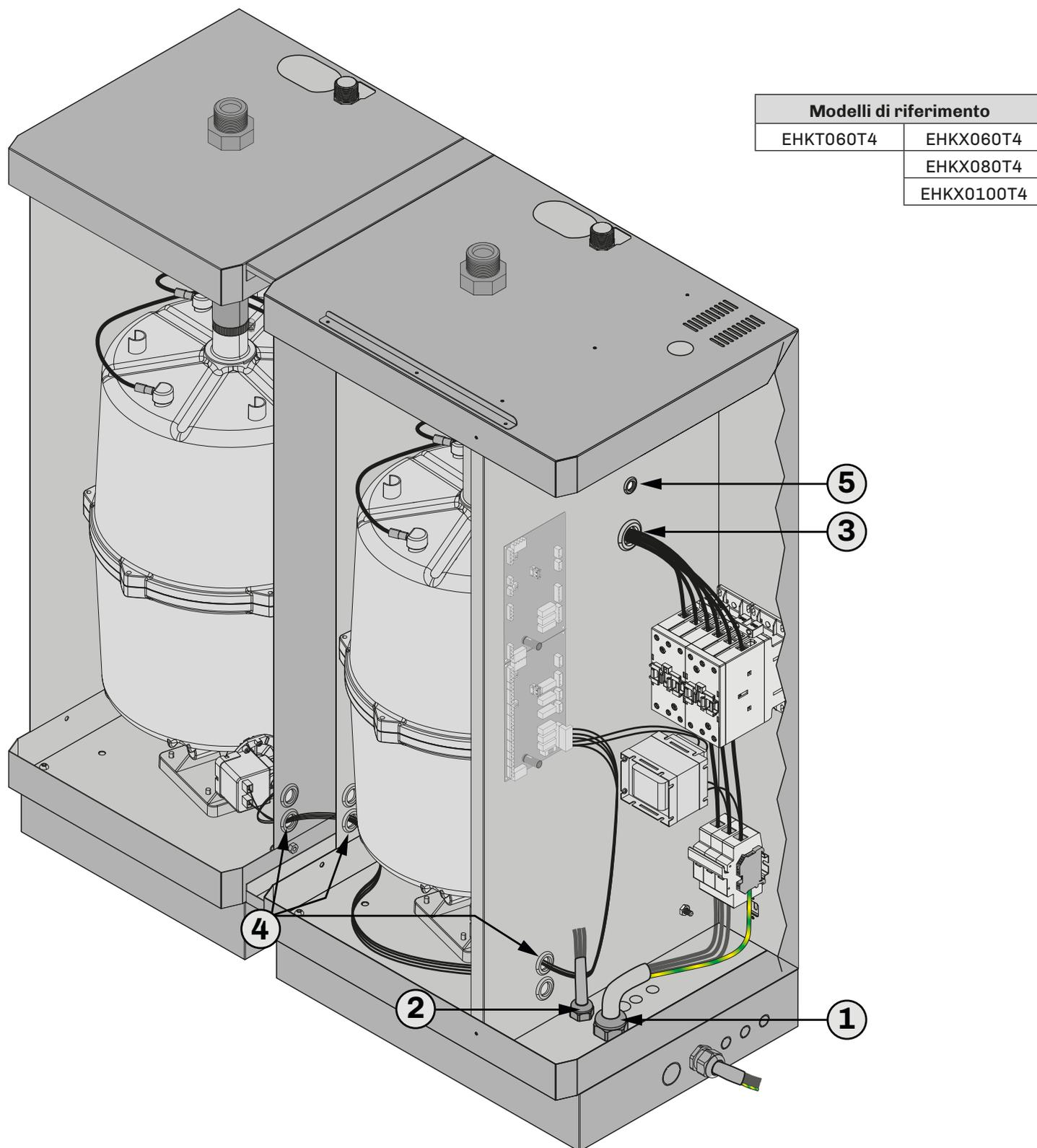
Fig. 105. Pressacavi e passaggio dei cavi
