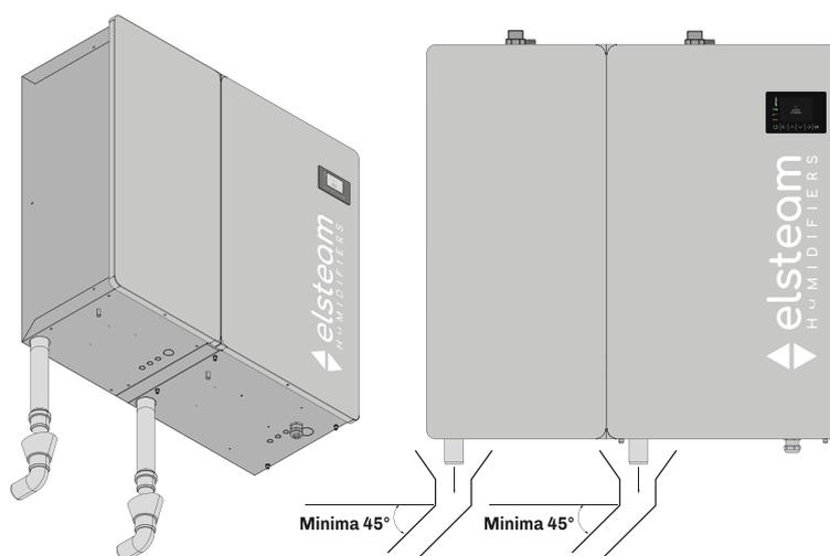
**Fig. 33.** Caratteristiche tubo drenaggio modelli doppio bollitore - scarichi separati
