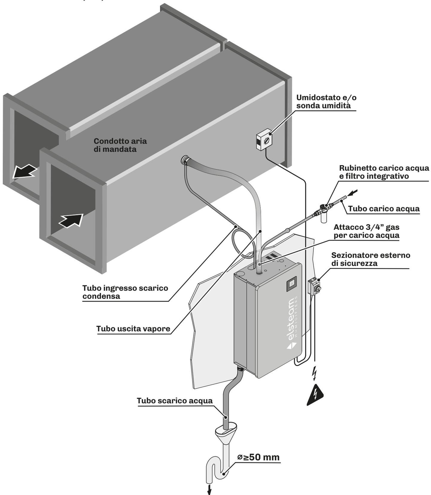
Fig. 45. Installazione tipica per l'umidificazione in canale
