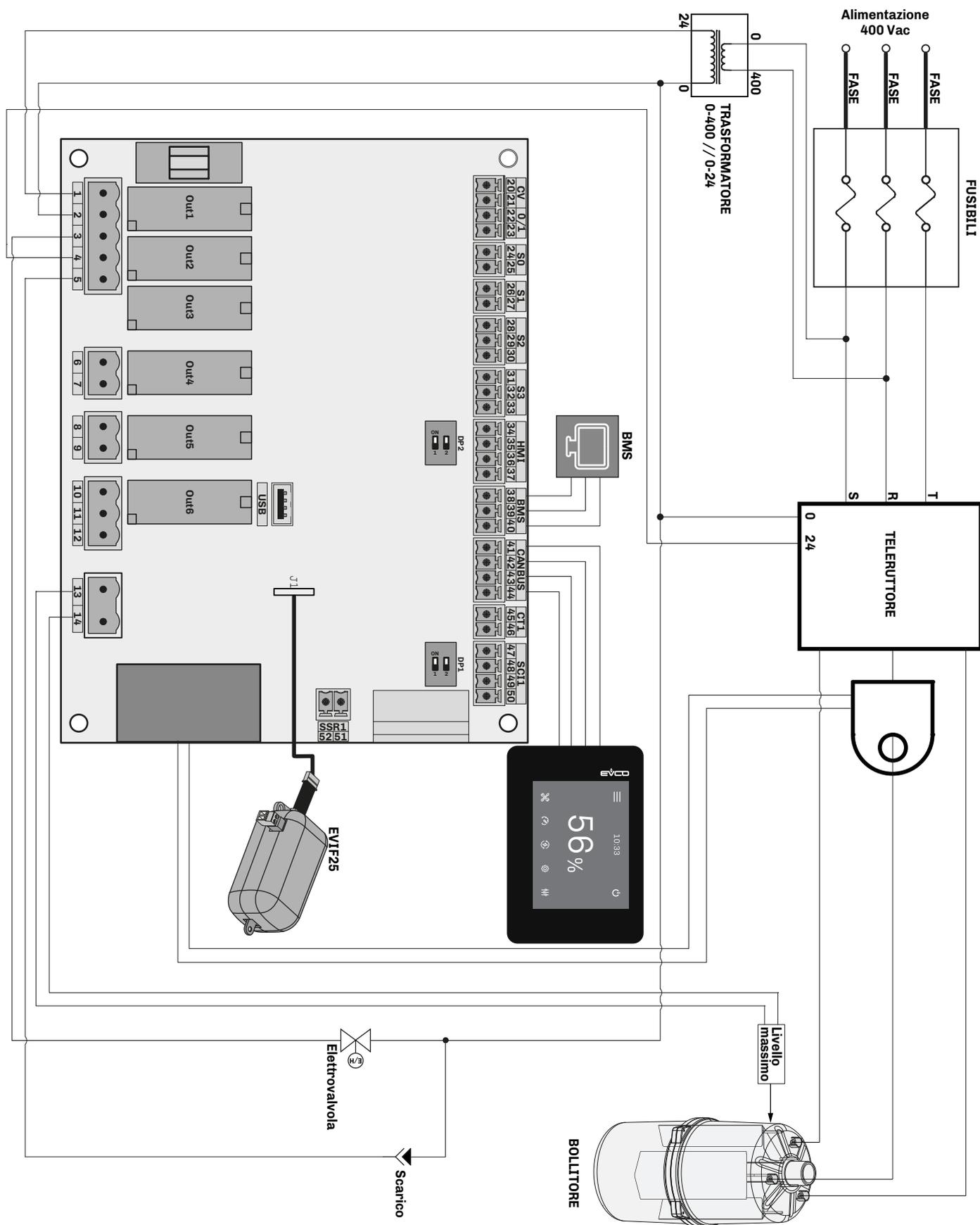
Fig. 125. Schema elettrico modelli EHKX003T4 / EHKX005T4 / EHKX010T4 / EHKX015T4 / EHKX020T4 / EHKX030T4 / EHKX040T4
