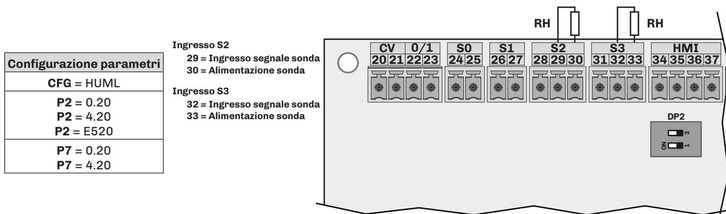
Fig. 60. Collegamento sonda di umidità e sonda limite (CFG = HUML)
