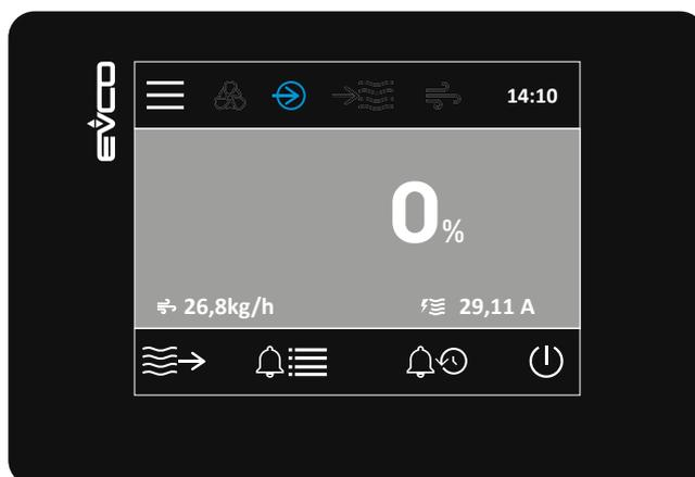
Fig. 19. Schermata di HOME con regolazione proporzionale - Interfaccia EHKX
