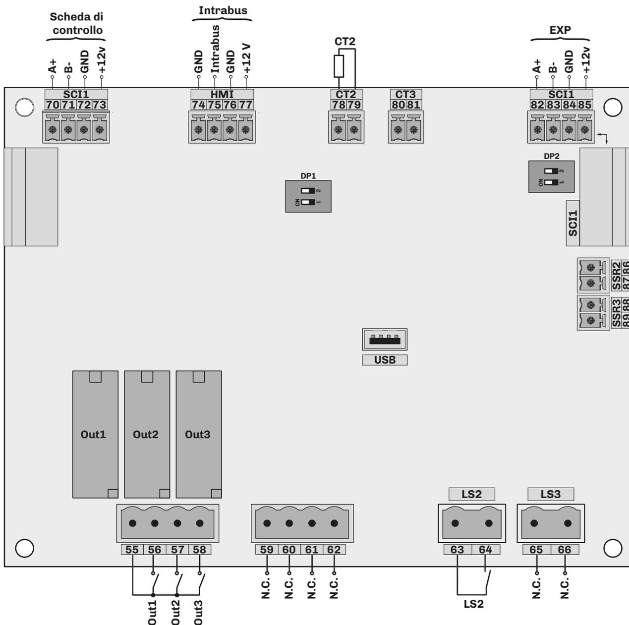
Fig. 93. Collegamenti elettrici espansione
