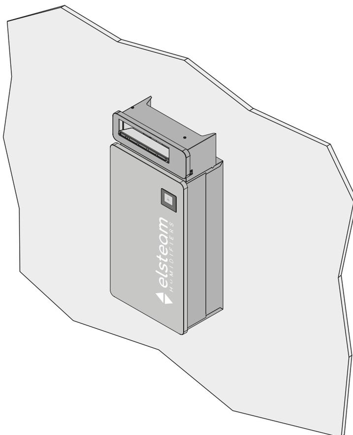
**Fig. 40.** Distribuzione di vapore ventilato in locale
