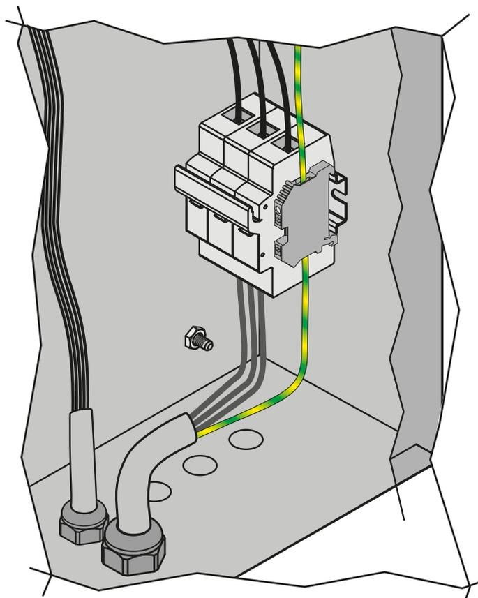
**Fig. 103.** Collegamenti elettrici alimentazione - modelli trifase
