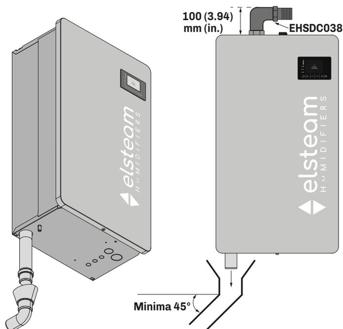
Fig. 32. Caratteristiche tubo drenaggio modelli singolo bollitore
