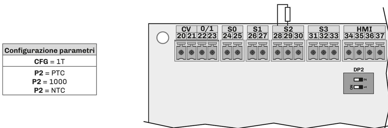
Fig. 61. Collegamento sonda di temperatura (CFG = 1T)
