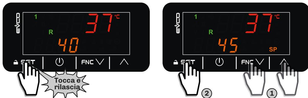
Fig. 11. Modifica setpoint temperatura
