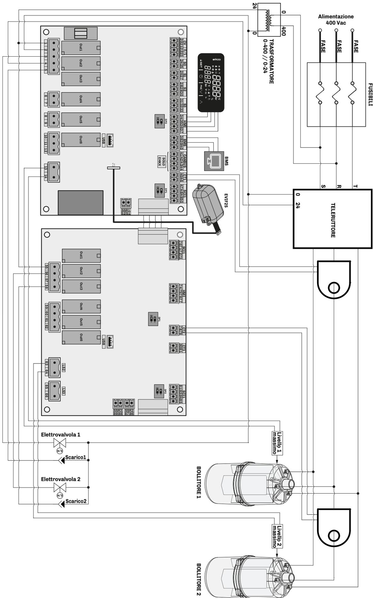
Fig. 122. Schema elettrico modelli EHKT060T4
