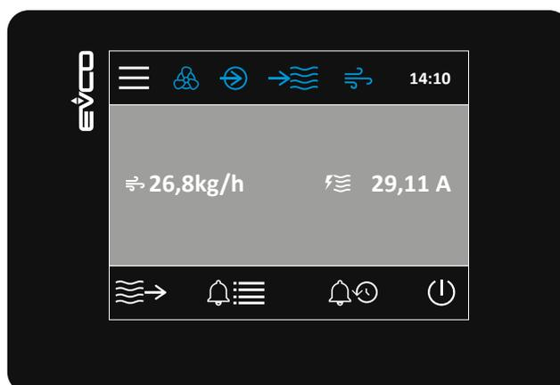
Fig. 15. Interfaccia umidificatore EHKX
