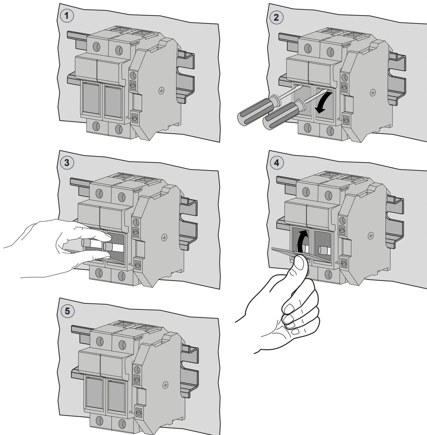
Fig. 51. Dispositivo di protezione da sovraccarico
