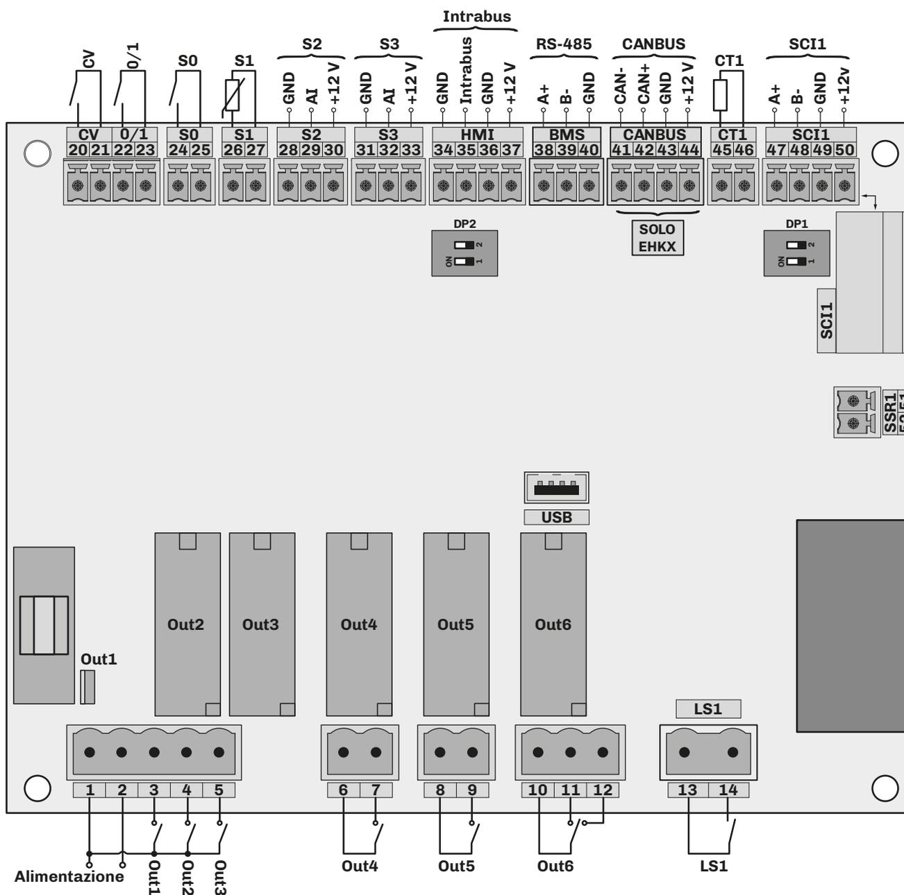
Fig. 54. Collegamenti elettrici scheda di controllo
