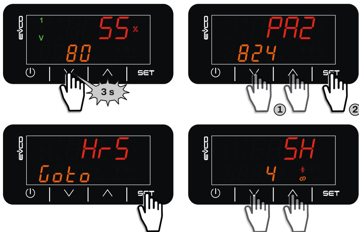
Fig. 72. Visualizzazione ore funzionamento
