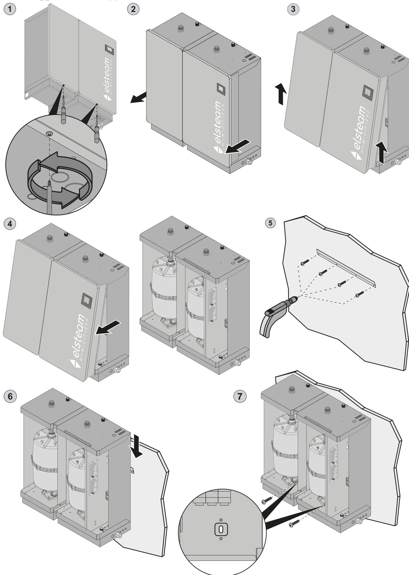
Fig. 83. Istruzioni di montaggio
