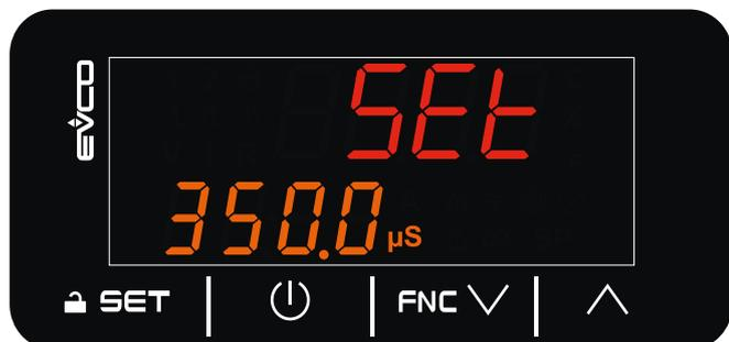
Fig. 4. Primo avvio - Impostazione conducibilità elettrica
