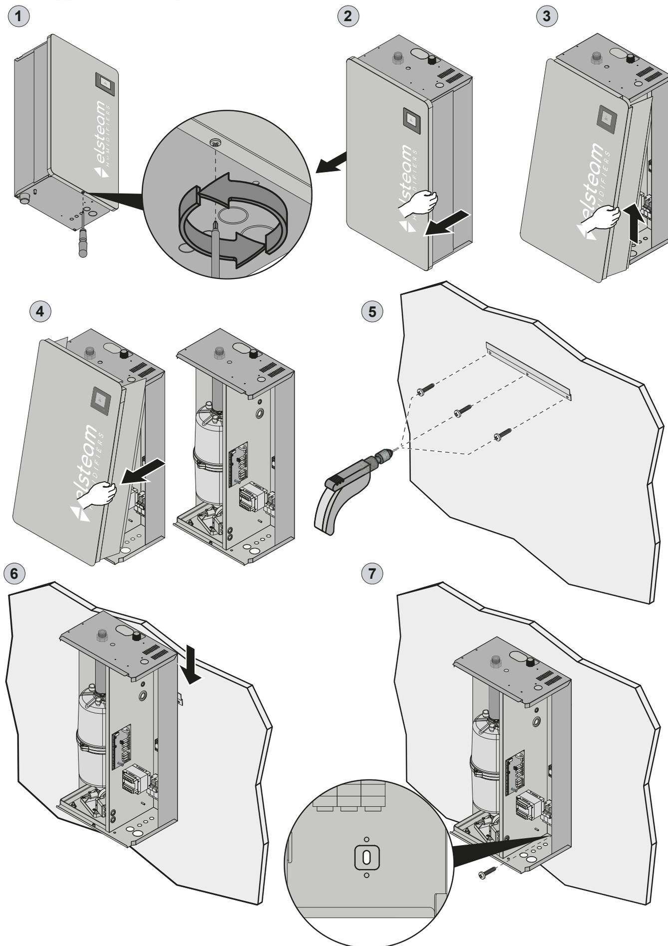
Fig. 82. Istruzioni di montaggio
