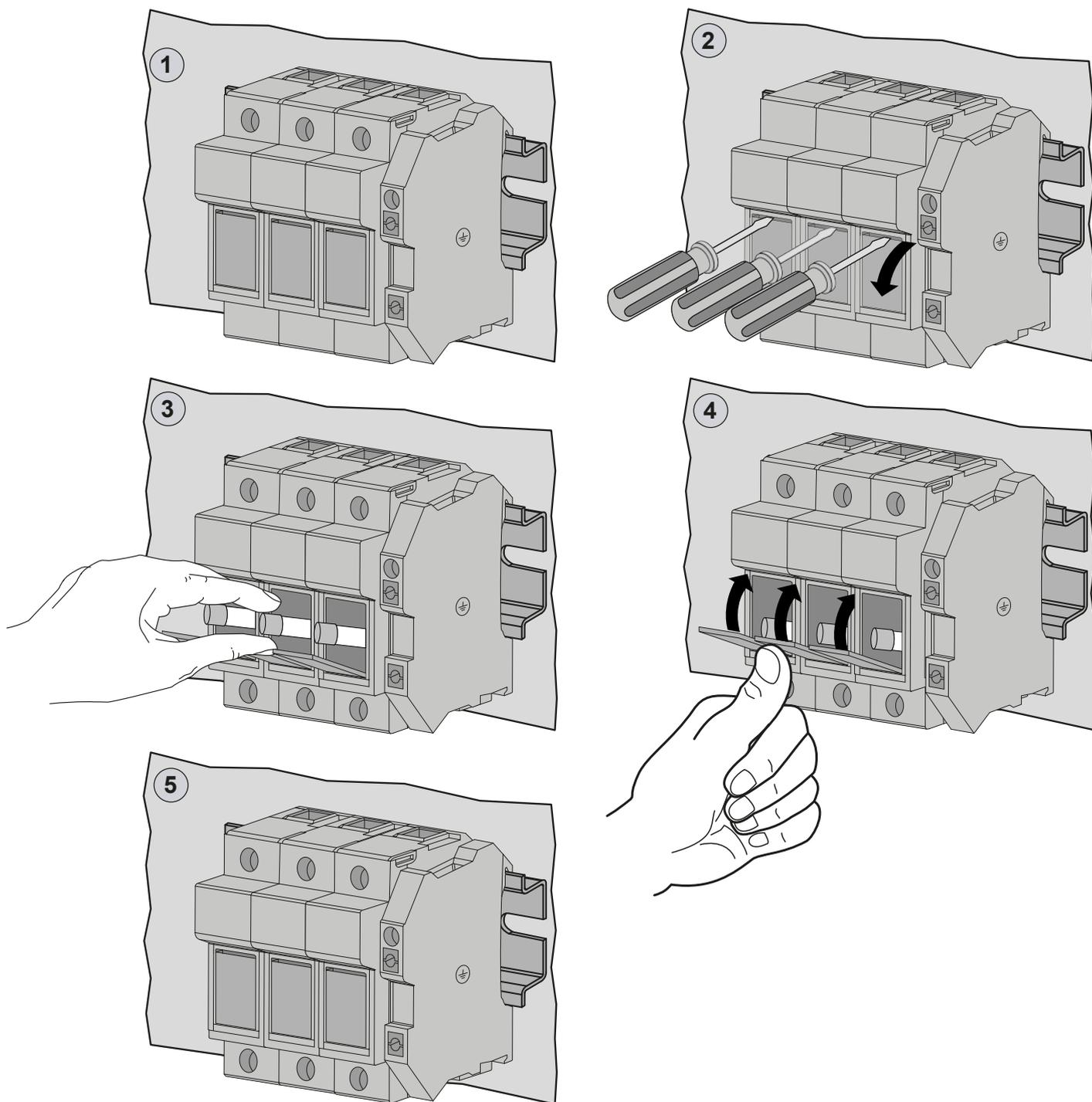
**Fig. 90.** Dispositivo di protezione da sovraccarico
