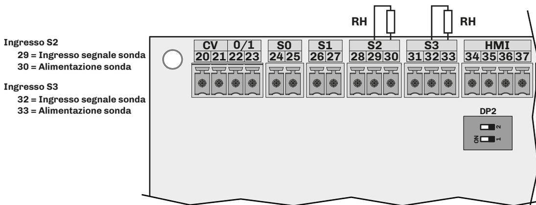
Fig. 98. Collegamento sonda di umidità e sonda limite (CFG = HUML)
