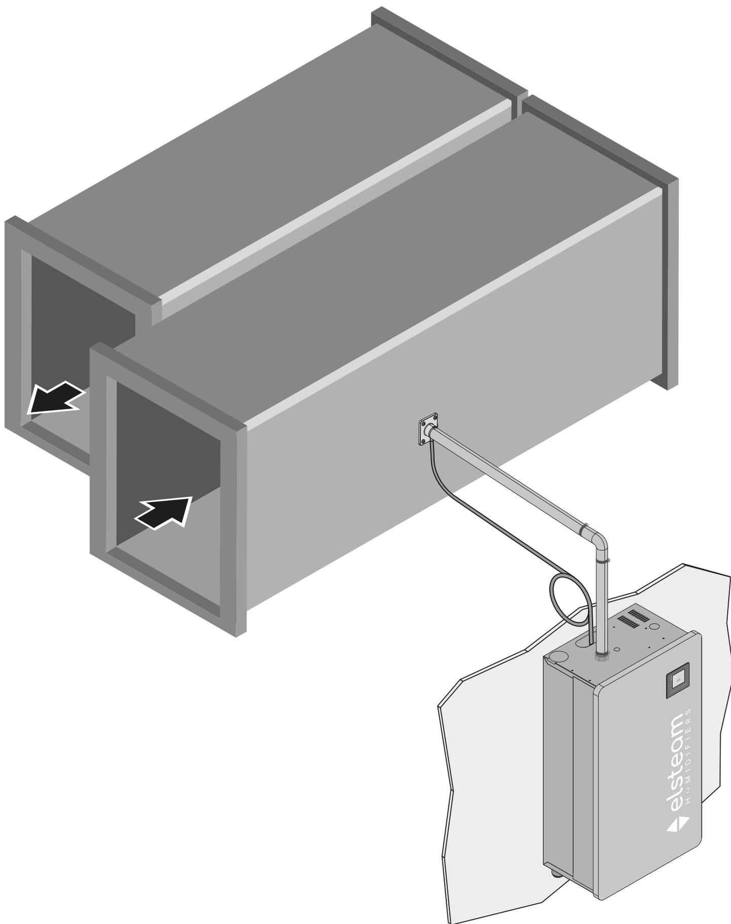
**Fig. 44.** Distributore di vapore ad ugello (in condotta)
