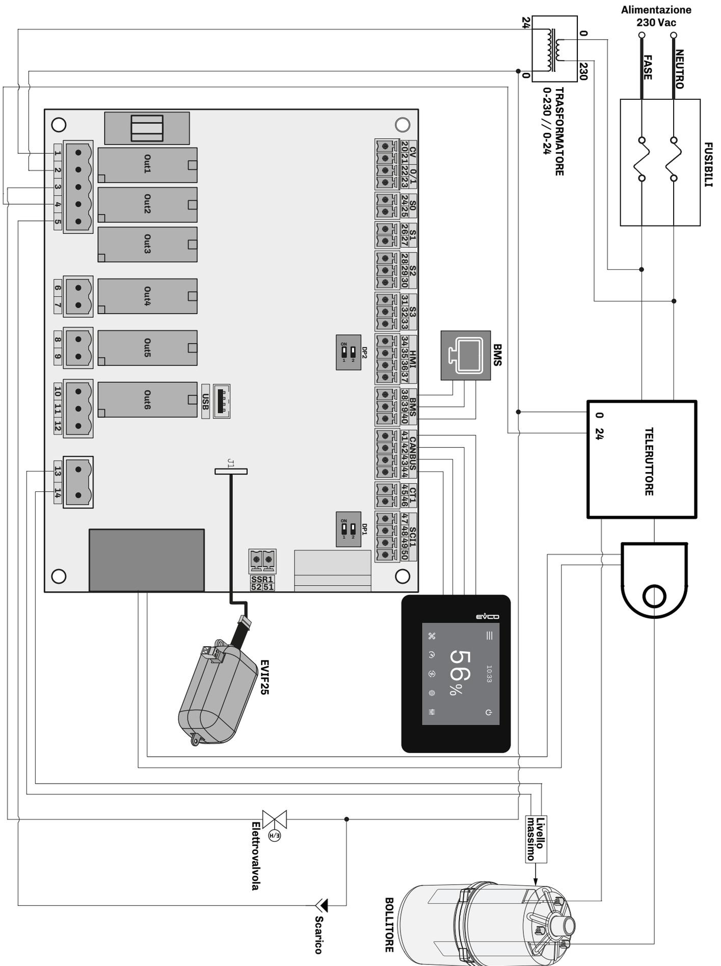
Fig. 123. Schema elettrico modelli EHKX003M2 / EHKX005M2
