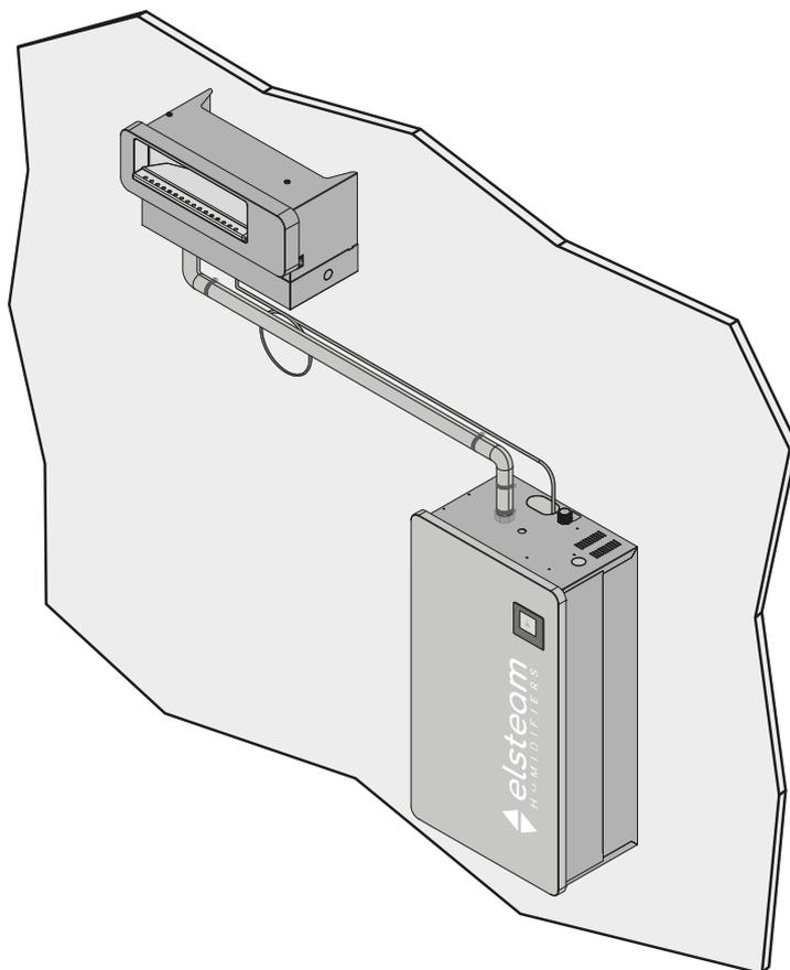
**Fig. 39.** Distribuzione di vapore ventilato remoto
