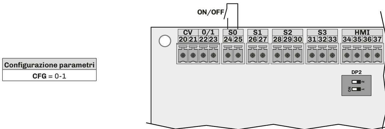
Fig. 94. Collegamento ON/OFF con umidostato o contatto esterno (CFG = 0-1)
