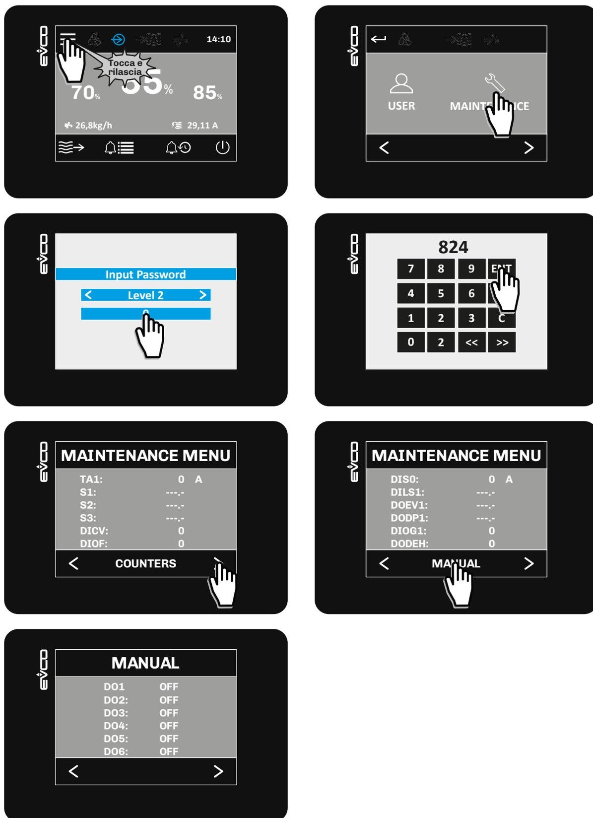
Fig. 76. Visualizzazione ore funzionamento
