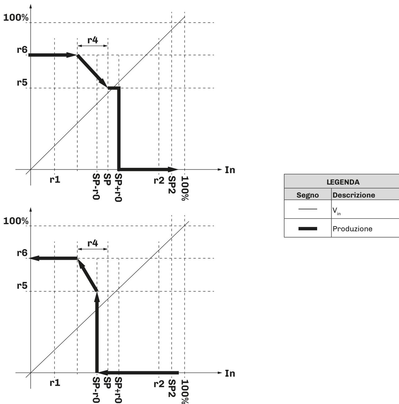
Fig. 108. Funzionamento della regolazione con sonda di umidità | CFG = HUM
