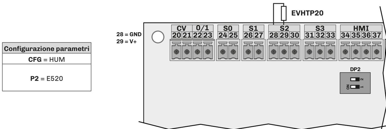
Fig. 59. Collegamento sonda di umidità EVHTP520 (CFG = HUM)
