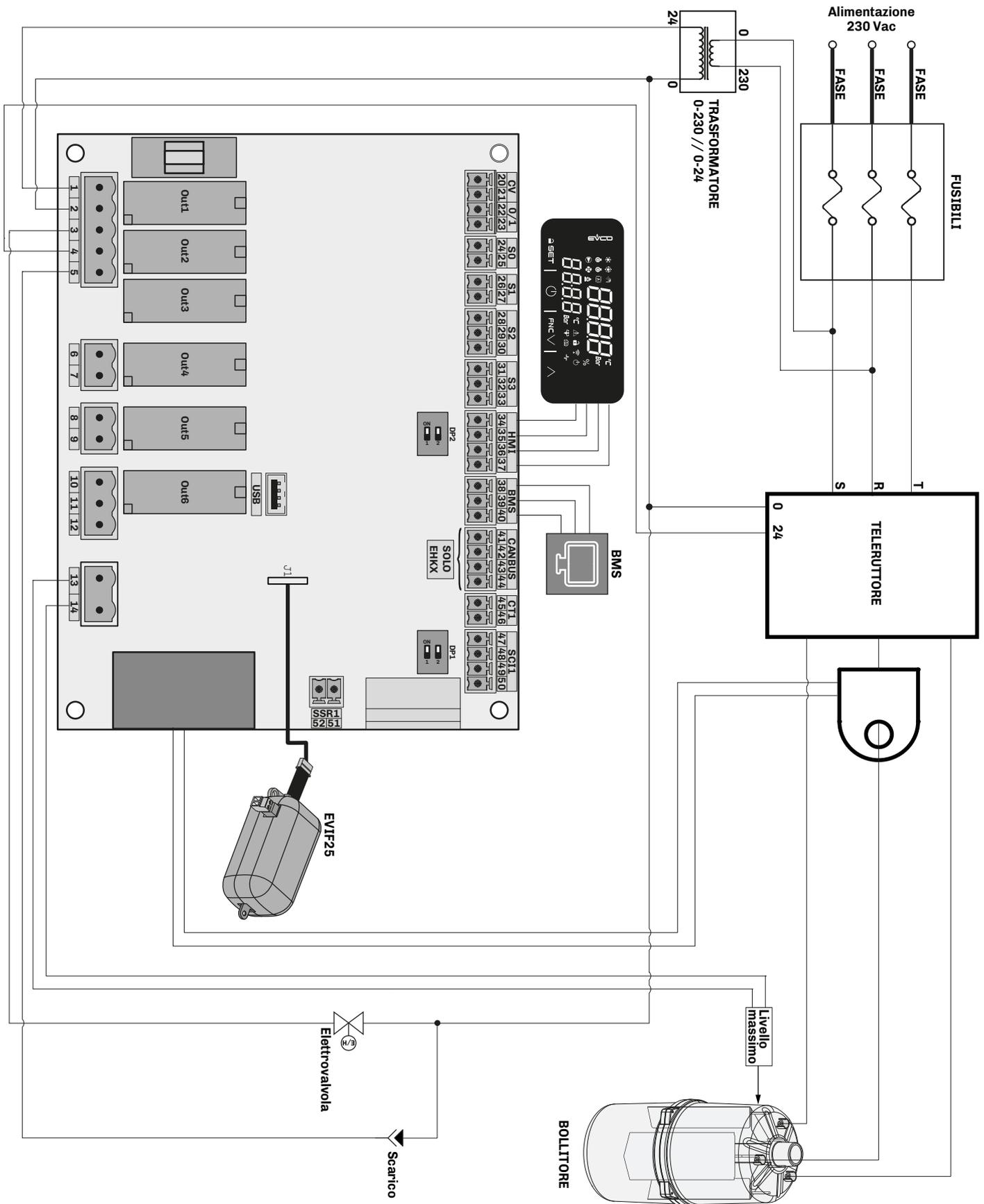
Fig. 119. Schema elettrico modelli EHKT003T2 / EHKT005T2 / EHKT010T2 / EHKT020T2
