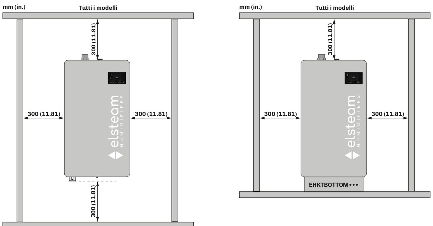
Fig. 81. Distanze minime di montaggio
