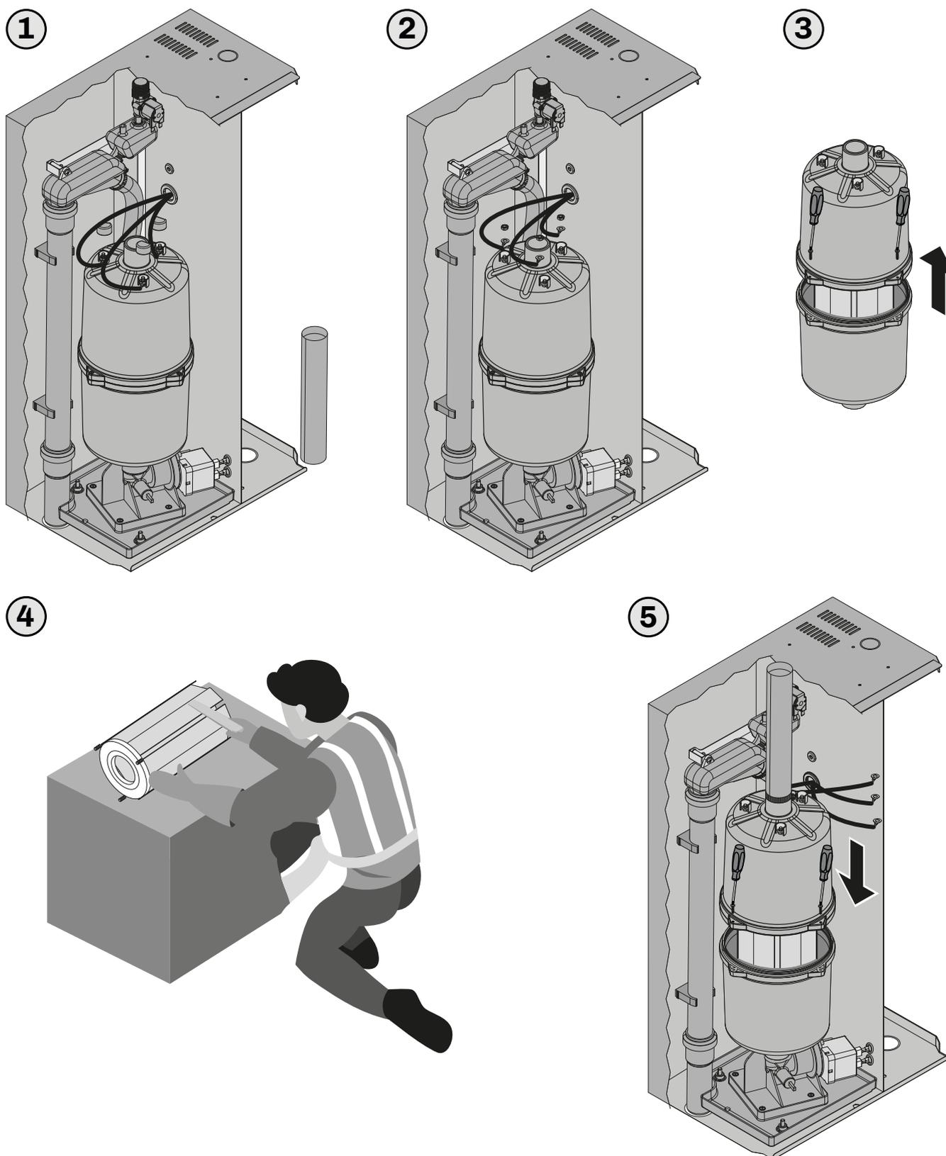
Fig. 115. Pulizia/sostituzione elettrodi
