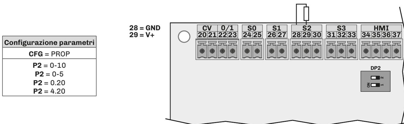
Fig. 95. Collegamento umidostato proporzionale esterno (CFG = PROP)
