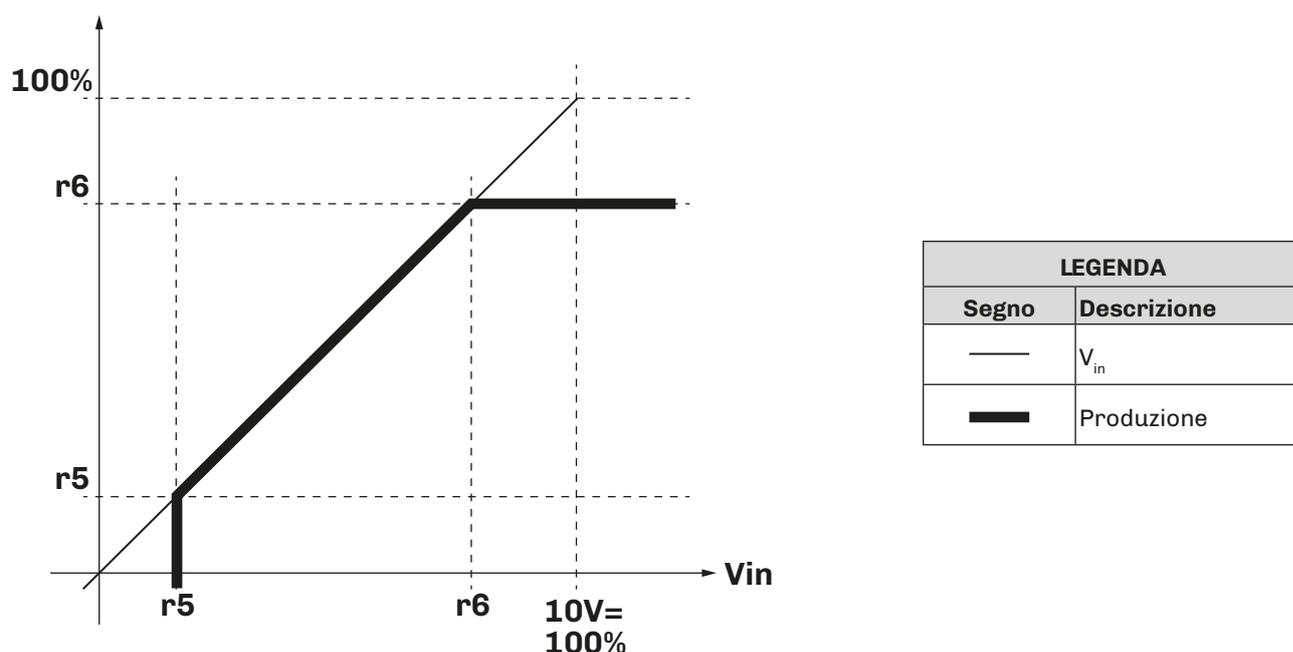
Fig. 107. Funzionamento della regolazione proporzionale | **CFG = PROP**
