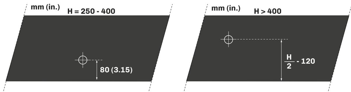
Fig. 35. Installazione orizzontale - 1 distributore
