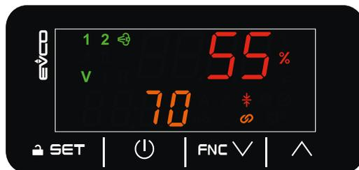
Fig. 9. Schermata di Home con sonda umidità e sonda limite
