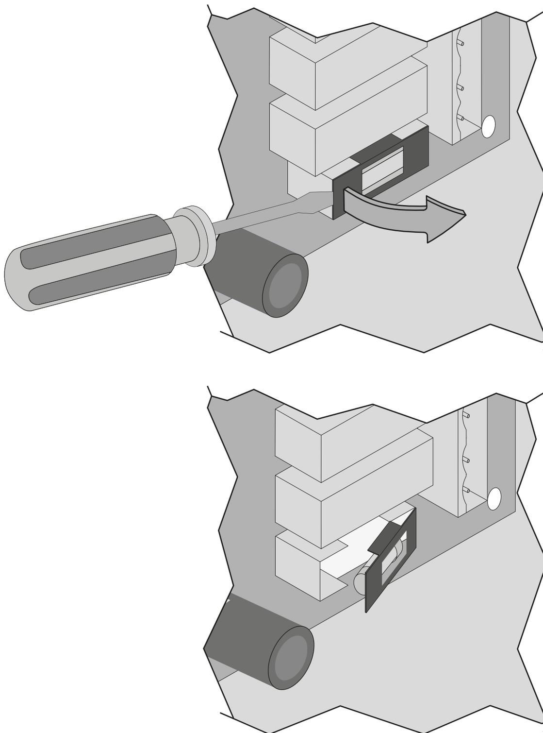
**Fig. 53.** Dispositivo di protezione su scheda di controllo
