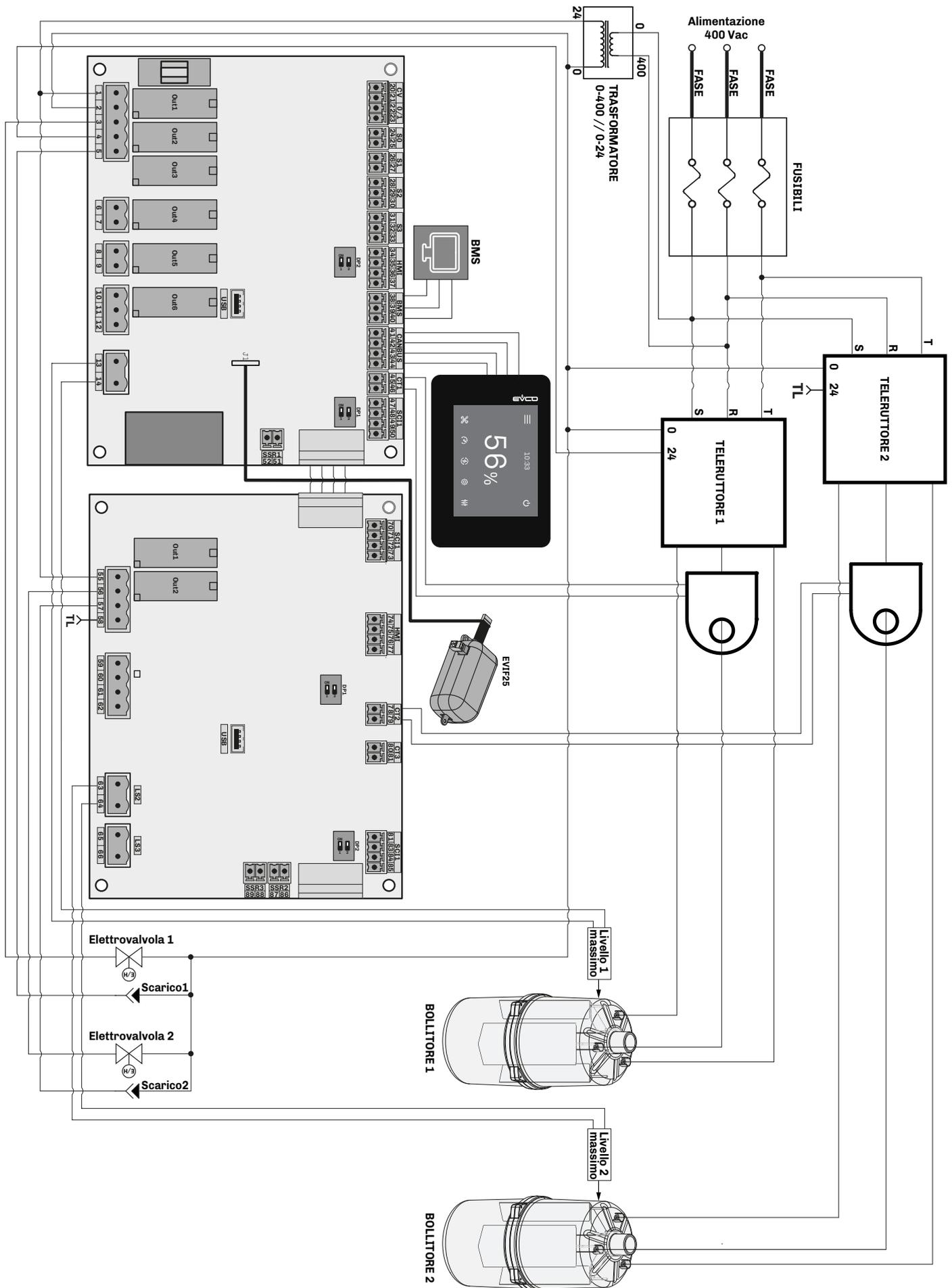
Fig. 126. Schema elettrico modelli EHKX060T4 / EHKX080T4 / EHKX0100T4
