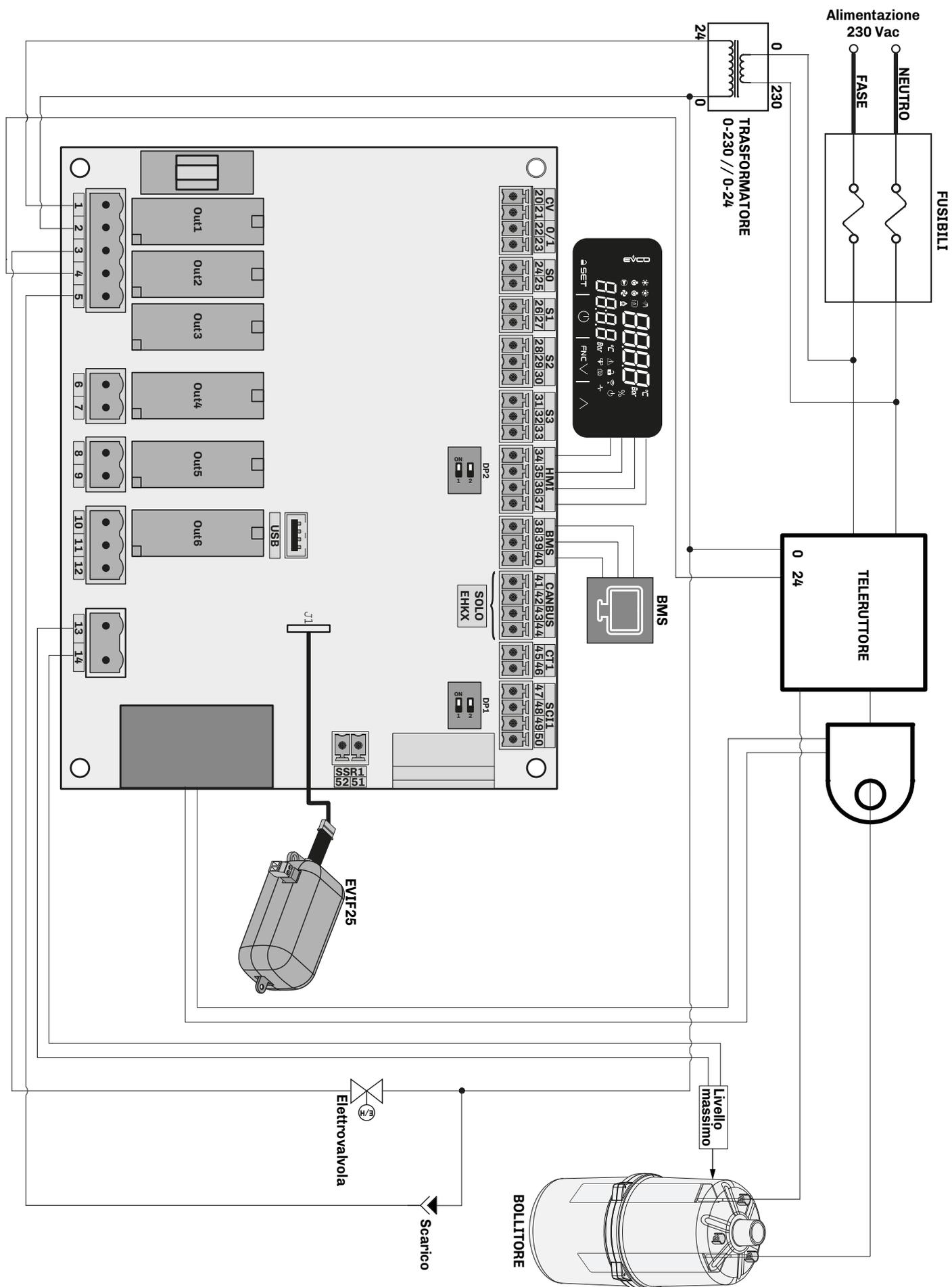
Fig. 118. Schema elettrico modelli EHKT003M2 / EHKT005M2
