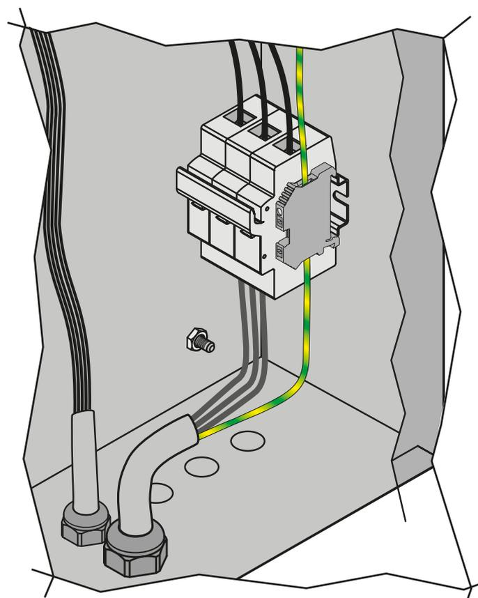
Fig. 65. Collegamenti elettrici alimentazione - modelli trifase
