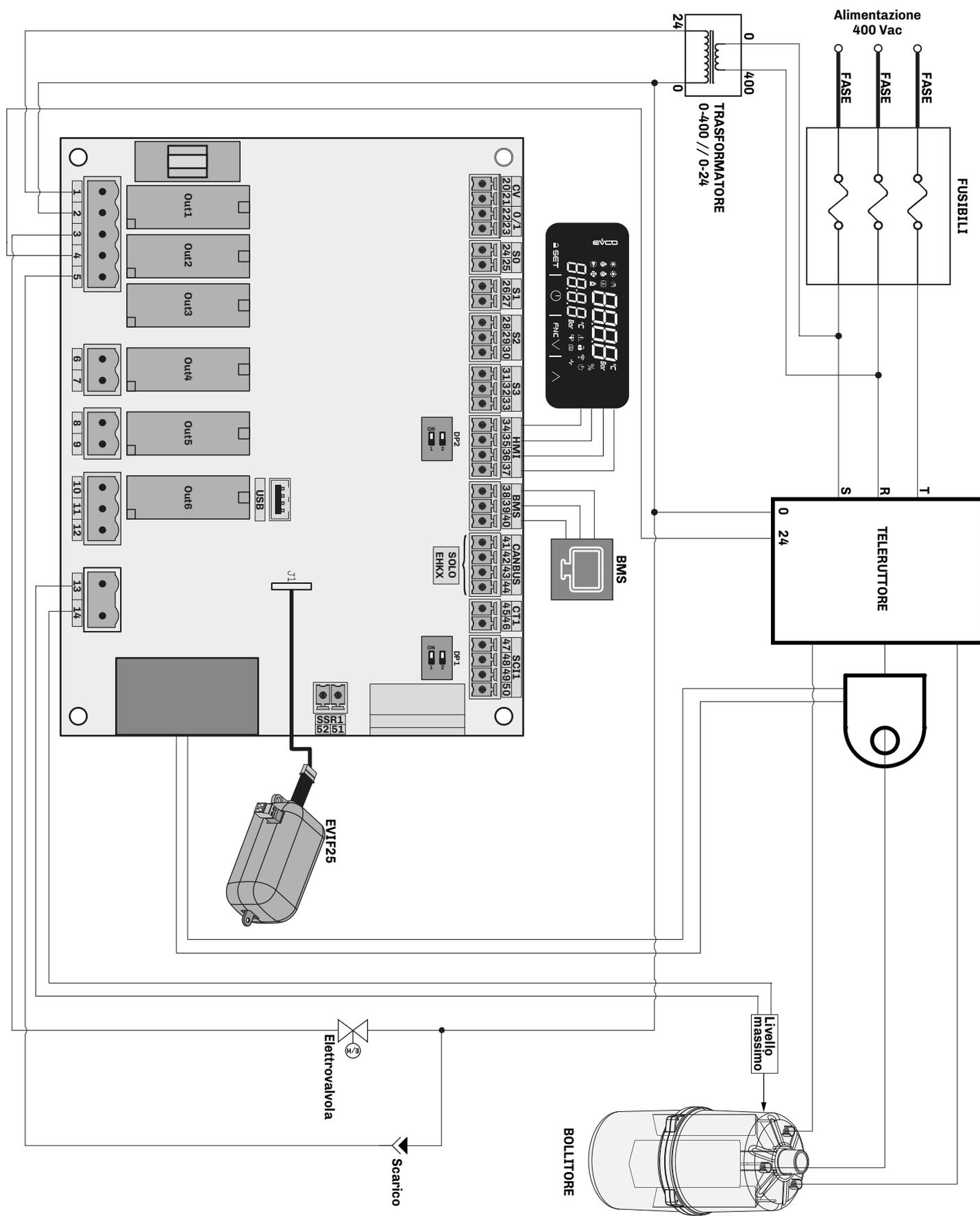
Fig. 121. Schema elettrico modelli EHKT020T4 / EHKT030T4 / EHKT040T4
