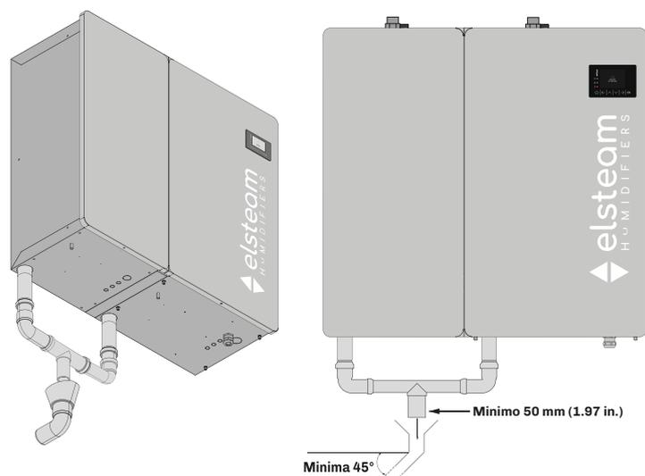
**Fig. 34.** Caratteristiche tubo drenaggio modelli doppio bollitore - unico scarico
