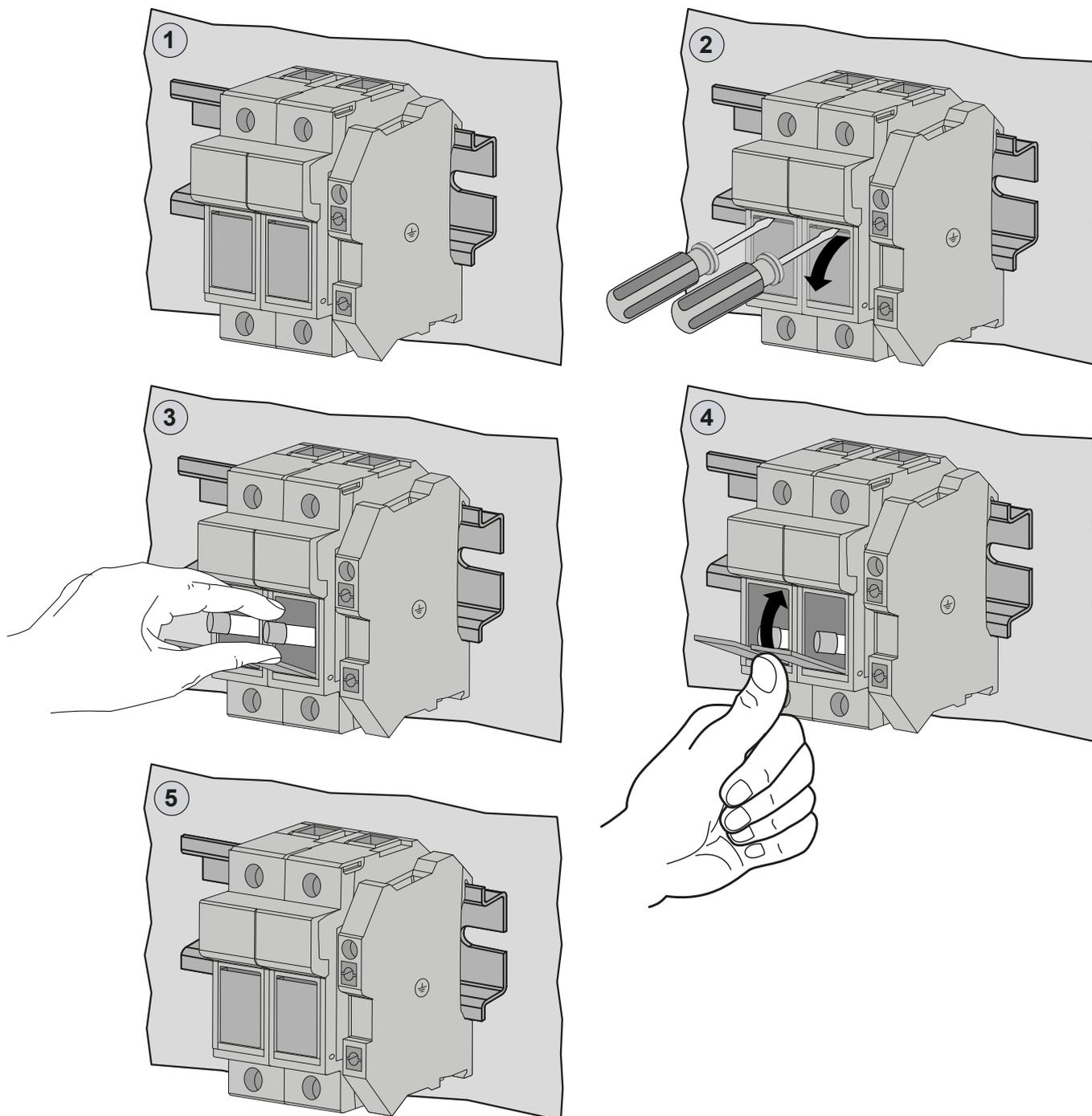
Fig. 89. Dispositivo di protezione da sovraccarico
