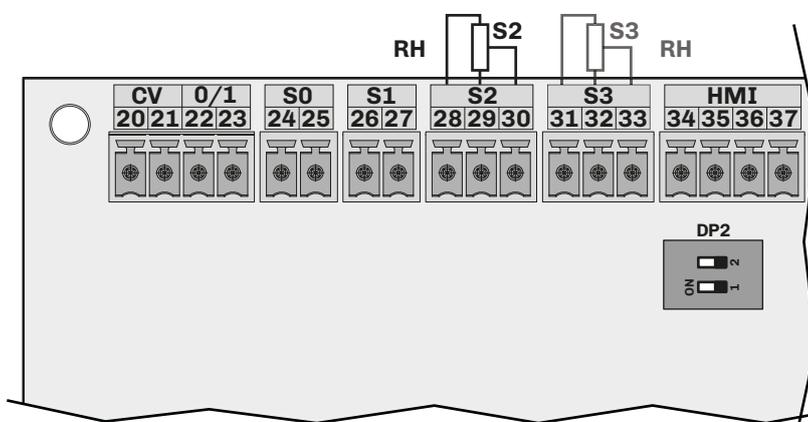
Fig. 101. Collegamento sonda di umidità 0...5 V
