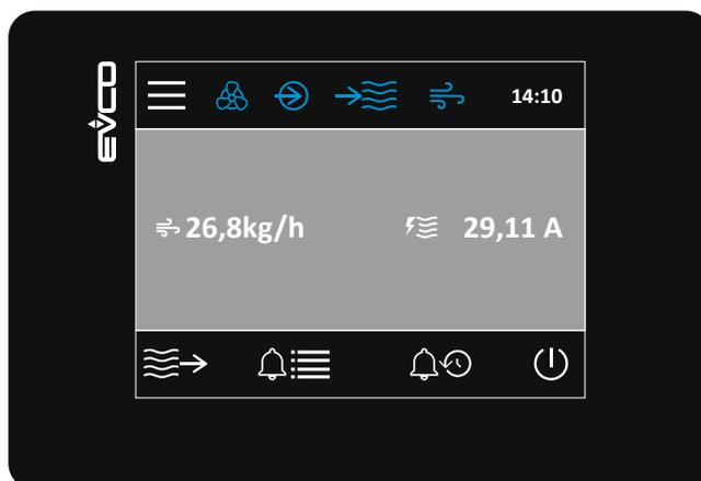
Fig. 18. Schermata HOME con regolazione ON/OFF da ingresso digitale - Interfaccia EHKX
