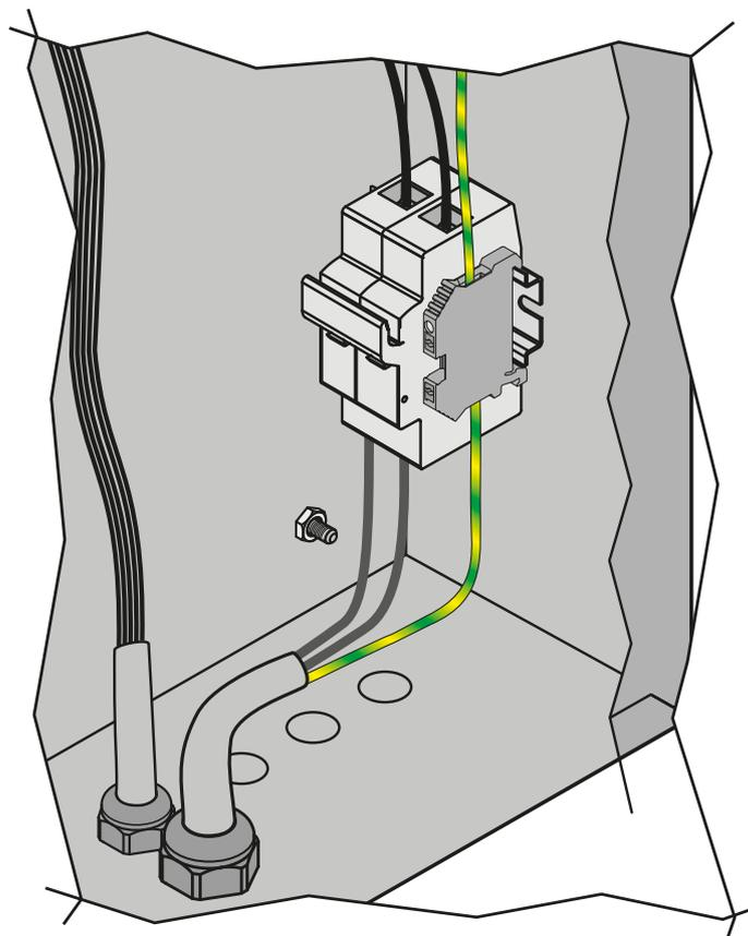
Fig. 64. Collegamenti elettrici alimentazione - modelli monofase
