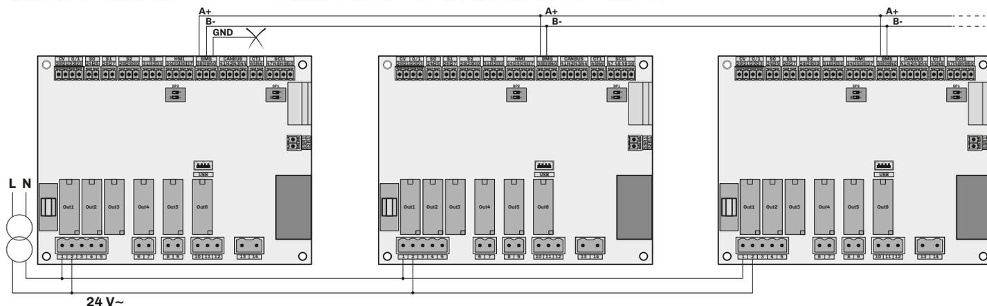
Fig. 68. Collegamenti linee seriali
