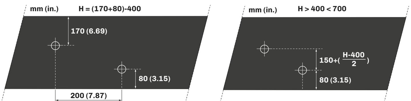
Fig. 36. Installazione orizzontale - 2 distributori
