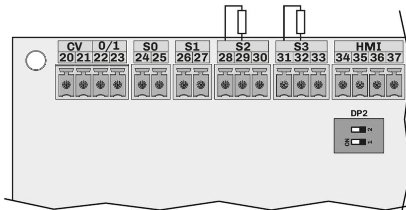
Fig. 62. Collegamento sonda di temperatura (CFG = 2T)
