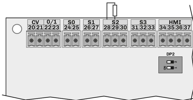
Fig. 99. Collegamento sonda di temperatura (CFG = 1T)
