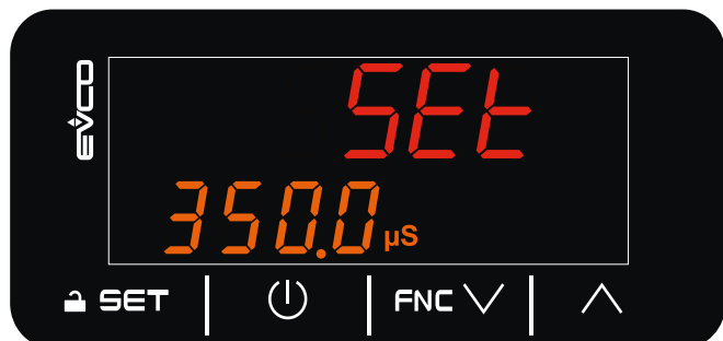
Fig. 4. Première mise en marche - Configuration de la conductivité électrique
