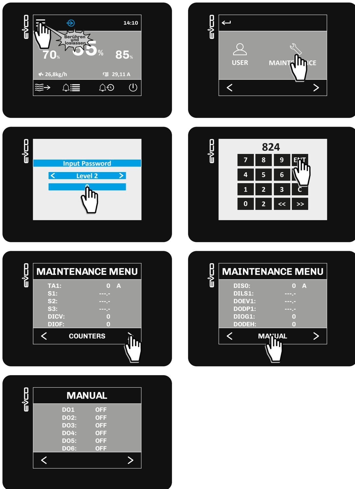
Fig. 77. Betriebsstunden anzeigen
