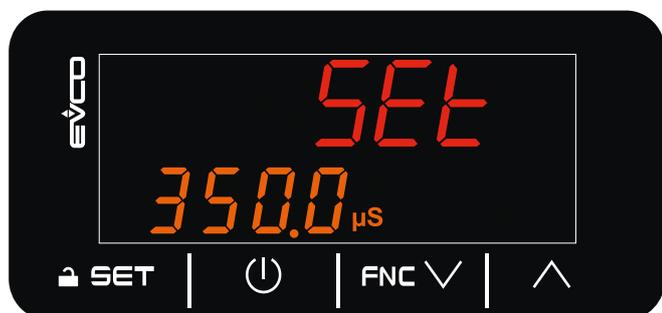
Fig. 35. Primo avvio - Impostazione conducibilità elettrica
