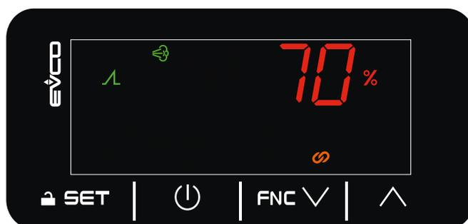
Fig. 38. Schermata di Home con regolazione proporzionale (CFG = PROP)
