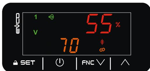
Fig. 39. Schermata di Home solo con sonda umidità
