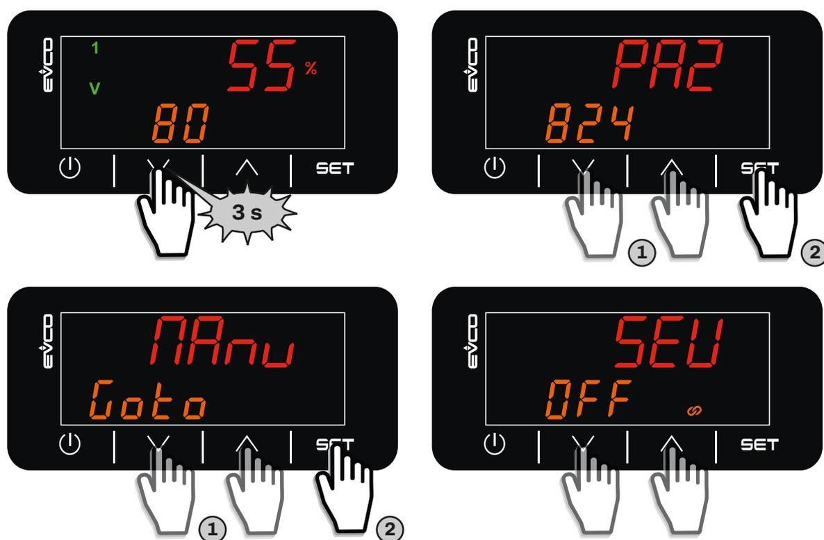
Fig. 48. Test funzionamento delle uscite
