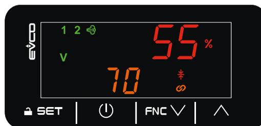
Fig. 40. Schermata di Home con sonda umidità e sonda limite
