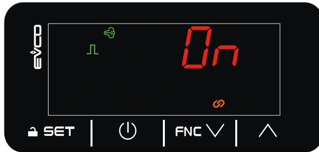
Fig. 37. Pantalla HOME con regulación ON/OFF por entrada digital (CFG = 0-1)
