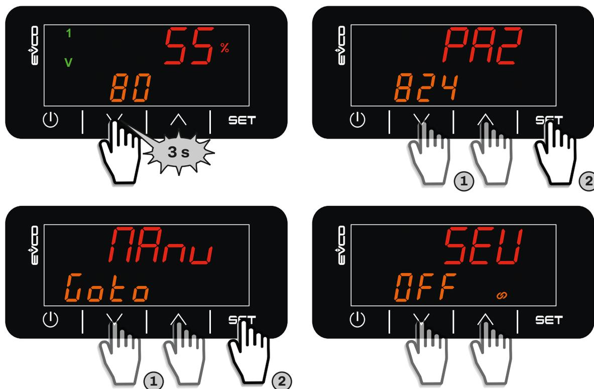
Fig. 48. Test de funcionamiento de las salidas
