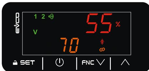
Fig. 40. Pantalla Home con sonda humedad y sonda límite
