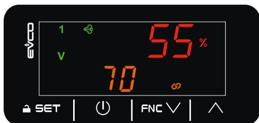
Fig. 58. Pantalla Home sólo con sonda humedad
