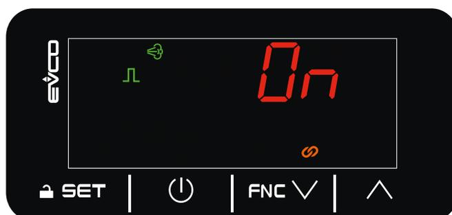
Fig. 56. Pantalla HOME con regulación ON/OFF por entrada digital (CFG = 0-1)
