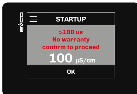
Fig. 47. Primera puesta en marcha - Configuración de la conductividad eléctrica
