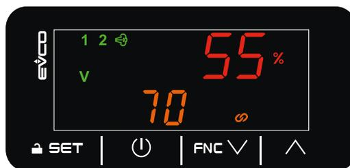
Fig. 59. Pantalla Home con sonda humedad y sonda límite
