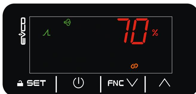
Fig. 57. Pantalla Home con regulación proporcional (CFG = PROP)
