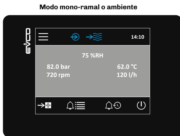
Fig. 50. Pantalla Home sólo con sonda humedad
