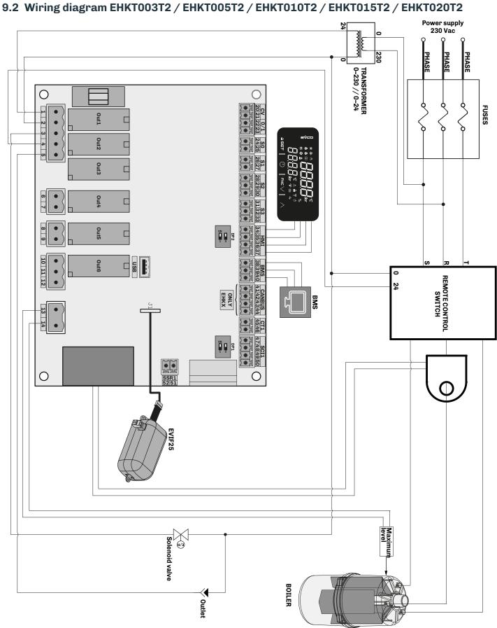
Fig. 120. Wiring diagram models EHKT003T2 / EHKT005T2 / EHKT010T2 / EHKT015T2 / EHKT020T2
