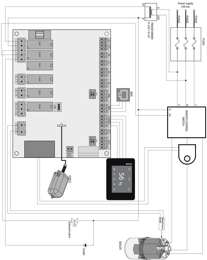
Fig. 126. Wiring diagram models EHKX003T4 / EHKX005T4 / EHKX010T4 / EHKX015T4 / EHKX020T4 / EHKX030T4 / EHKX040T4
