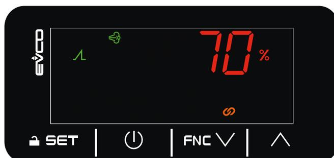
Fig. 7. Page-écran d'Accueil avec réglage proportionnel (CFG = PROP)
