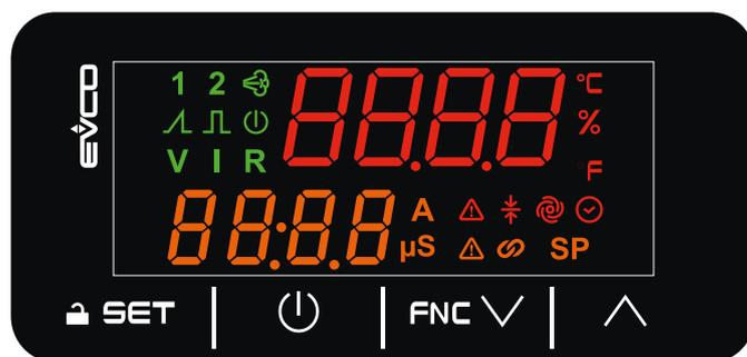
Fig. 3. Benutzerschnittstelle EHKT-Befeuchter
