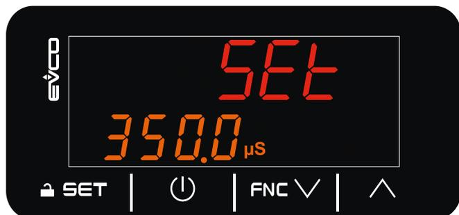
Fig. 4. Erstanlauf - Eingabe der elektrischen Leitfähigkeit
