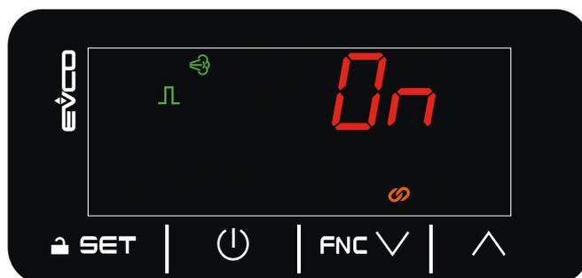
Fig. 6. Seite Home für die ON/OFF-Regelung über digitalen Eingang (CFG = 0-1)
