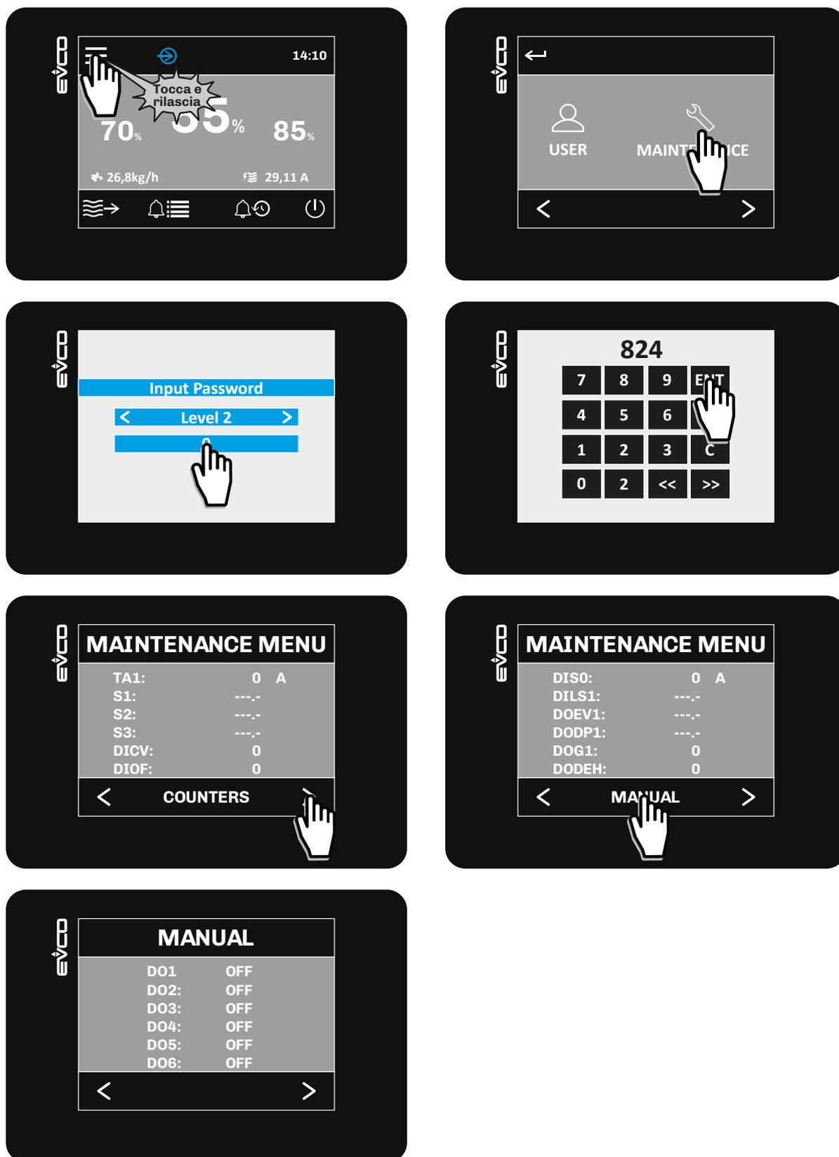
Fig. 76. Visualizzazione ore funzionamento
