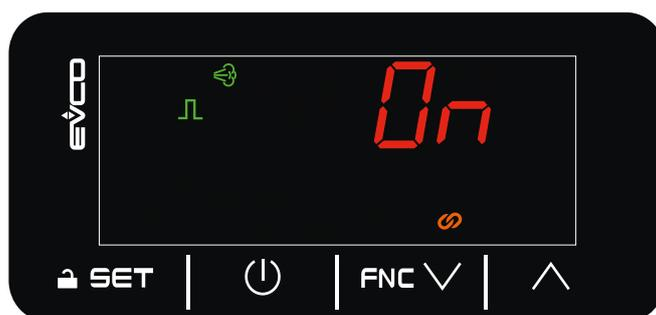
Fig. 6. Schermata di Home on regolazione ON/OFF da ingresso digitale (CFG = 0-1)
