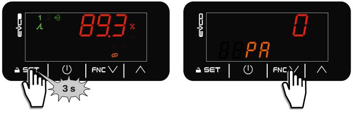
Fig. 33. Accessing the user parameters menu
