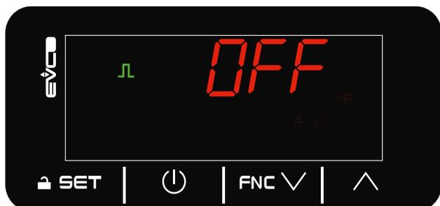
Fig. 28. Funzionamento ON/OFF - ID1 e ID2 aperto
