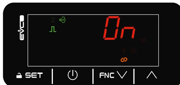
Fig. 29. Funzionamento ON/OFF - ID1 e ID2 chiuso
