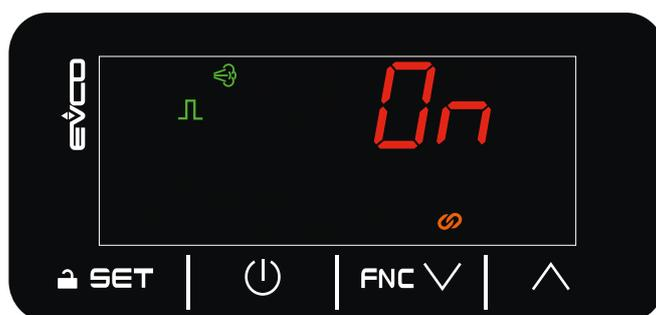
Fig. 34. Schermata di Home on regolazione ON/OFF da ingresso digitale (CFG = 0-1)
