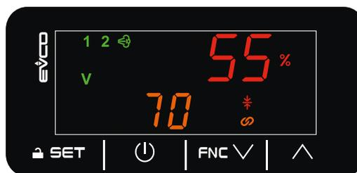
Fig. 37. Schermata di Home con sonda umidità e sonda limite
