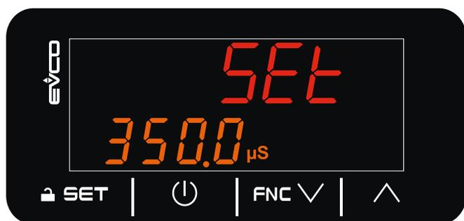
Fig. 32. Primo avvio - Impostazione conducibilità elettrica
