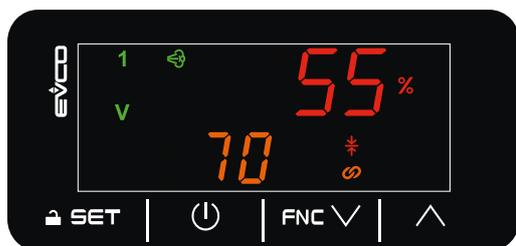
Fig. 36. Schermata di Home solo con sonda umidità
