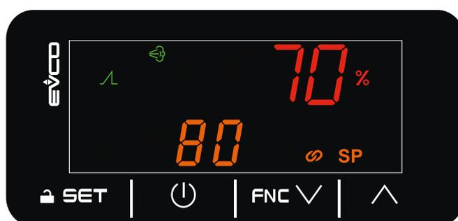
Fig. 35. Schermata di Home con regolazione proporzionale (CFG = PROP)
